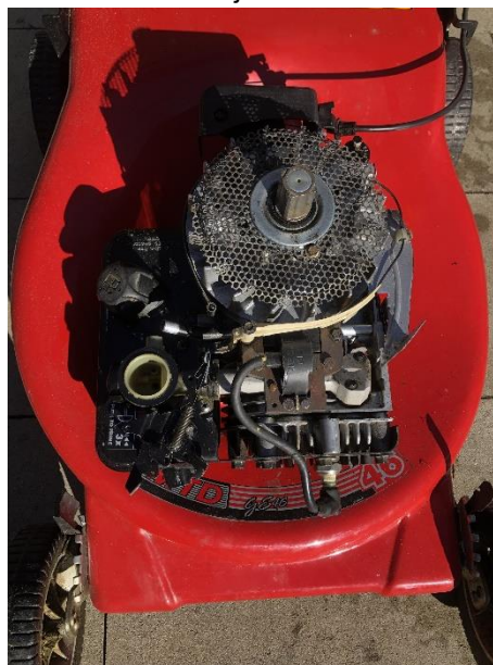
Slika 8: Skoraj v celoti sestavljena starejša kosilnica z obnovljenimi in očiščenimi deli
