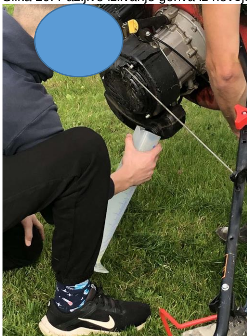
Slika 10: Pazljivo izlivanje goriva iz novejše kosilnice
