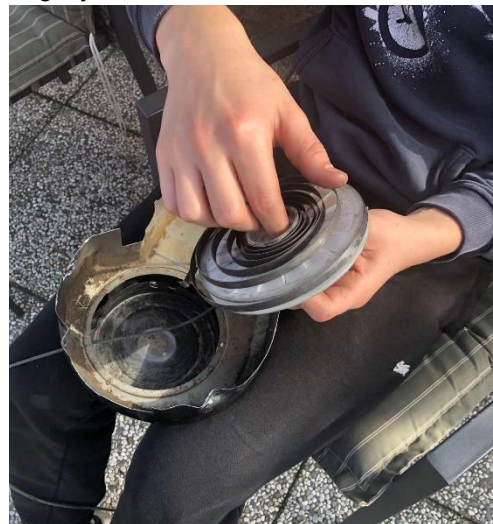
Slika 4: Poskus popravila povratnega zaganjalnika
