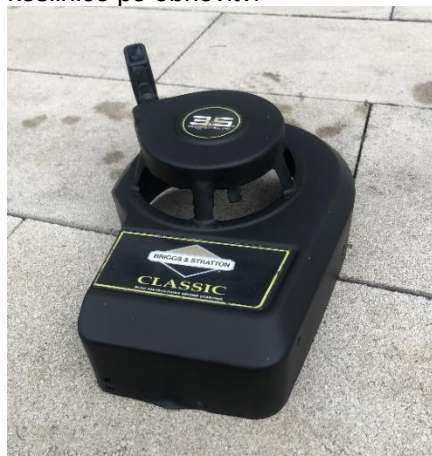
Slika 6: Povratni zaganjalnik s pokrovom kosilnice po obnovitvi
