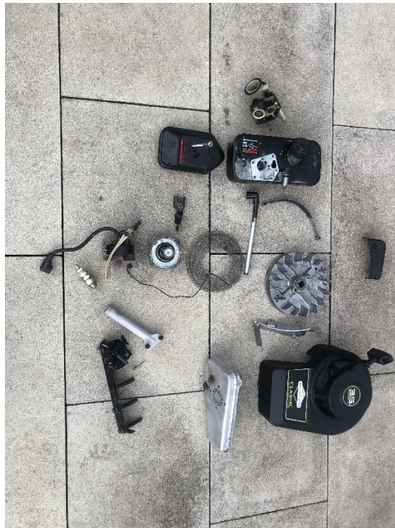
Slika 17: Obnovljeni in očiščeni deli starejše kosilnice
