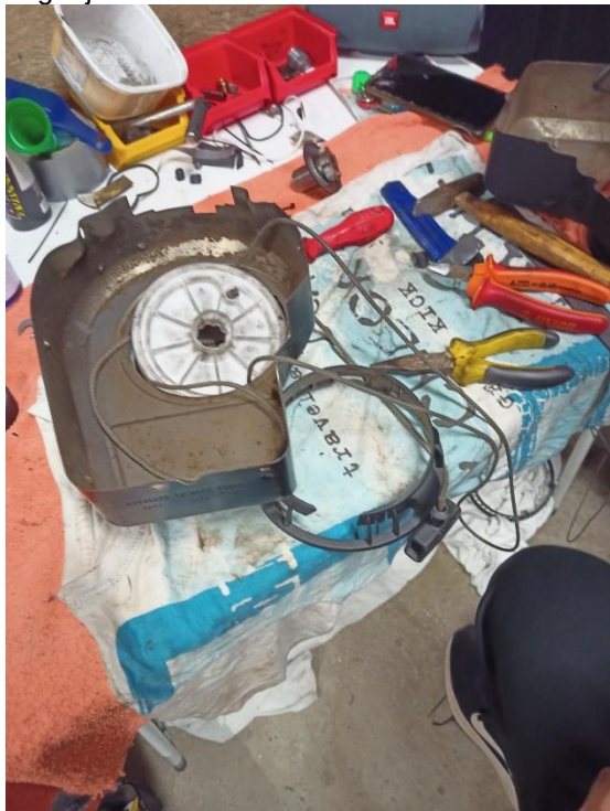
Slika 16: Poskus popravila povratnega zaganjalnika
