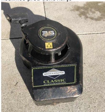
Slika 5: Povratni zaganjalnik s pokrovom kosilnice pred obnovitvijo
