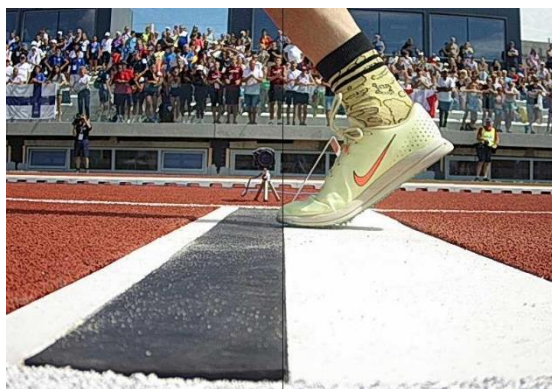
Slika 4: primer določitve veljavnosti skoka z visokofrekvenčno kamero (lasten vir)
