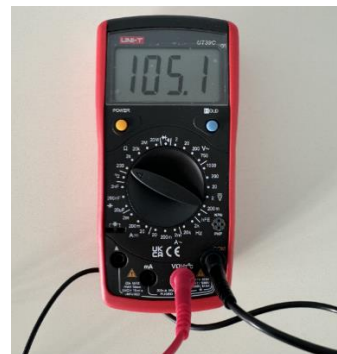
Slika 11: Testna meritev upornosti na piezo senzorju (lasten vir)
