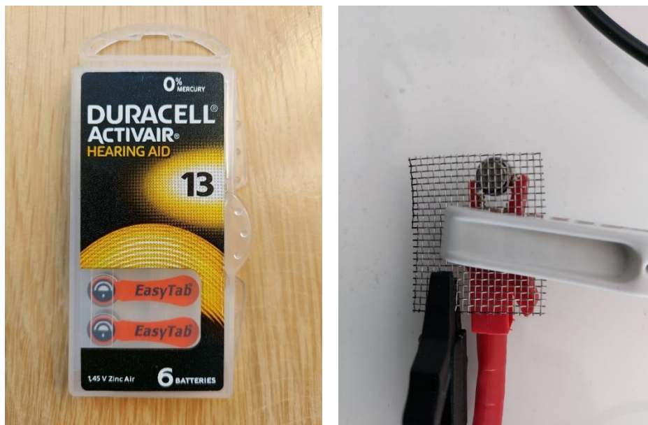
Slika 35: Komercialna baterija DURACELL TIP 13: levo. Priklop baterije na merilno napravo SIGLENT: desno (lasten vir)
