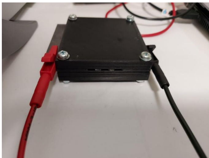
Slika 33: Priključitev naše baterije na merilno napravo SIGLENT (lasten vir)
