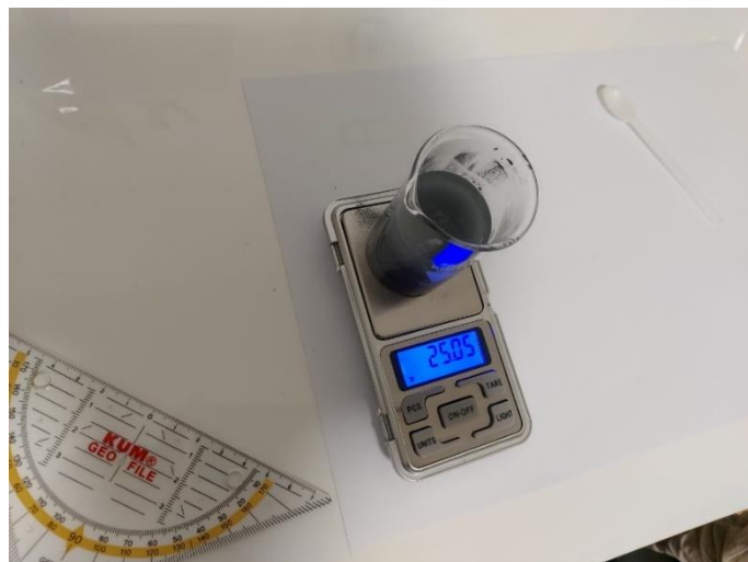
Slika 17: Tehtanje cinkovega prahu (lasten vir)
