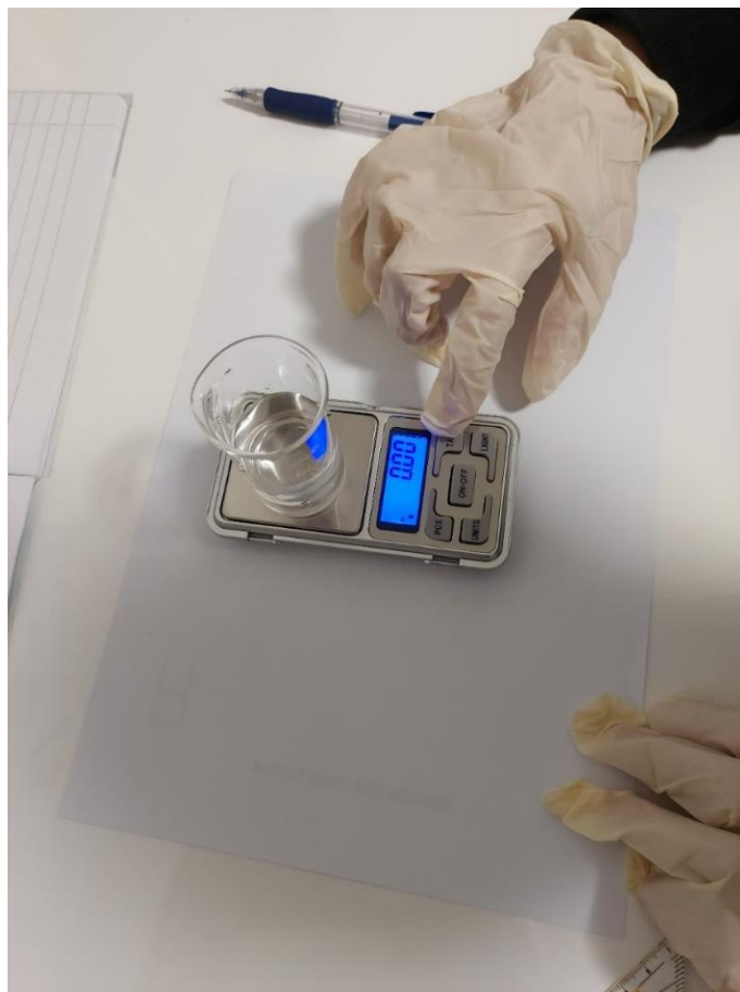
Slika 12: Čaša z destilirano vodo, nastavitev ničelne teže (tara) na tehtnici (lasten vir)
