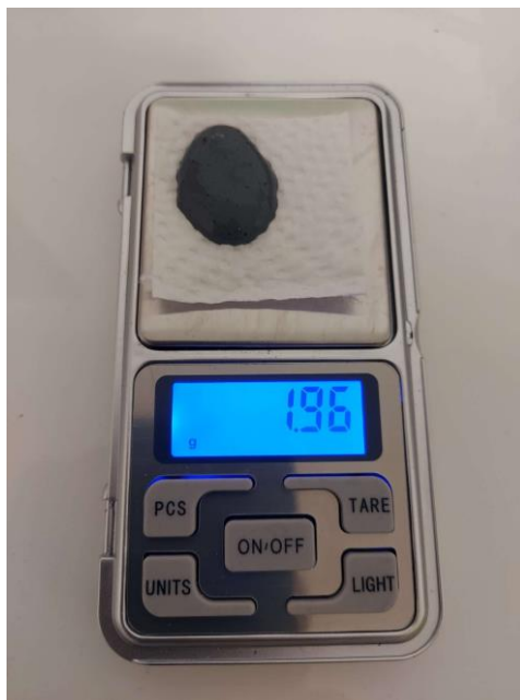
Slika 41: Tehtanje aktivne snovi naše baterije cink-zrak. (lasten vir)
