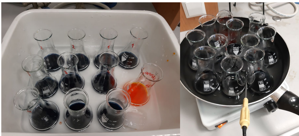
SLIKA 3: VZORCI V HLADNI VODNI KOPELI (LEVO) IN SEGREVANJE VZORCEV (DESNO) (LASTEN VIR)
