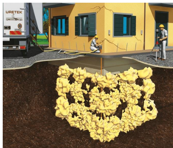
Slika 15: Dvigovanje temelja z tehnologijo Deep Injections®
