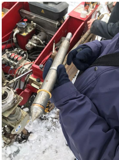
Slika 7: Slika sonde, ki jo vtiskamo v tla
