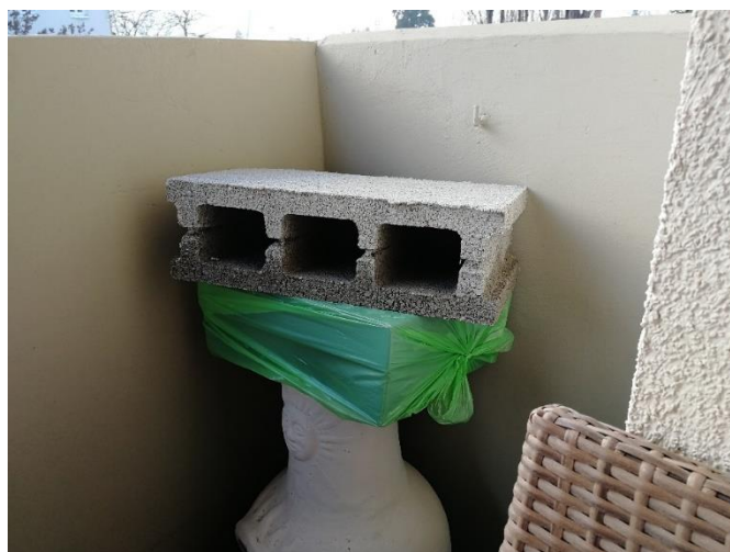
Slika 47: Naravno vlaženje in sušenje betonske opeke
