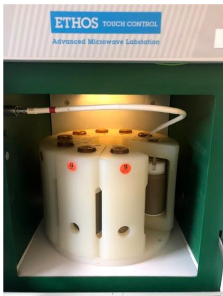
SLIKA 9: NAMEŠČENI KOLUTI V MIKROVALOVNEM SISTEMU (OSEBNI ARHIV)
