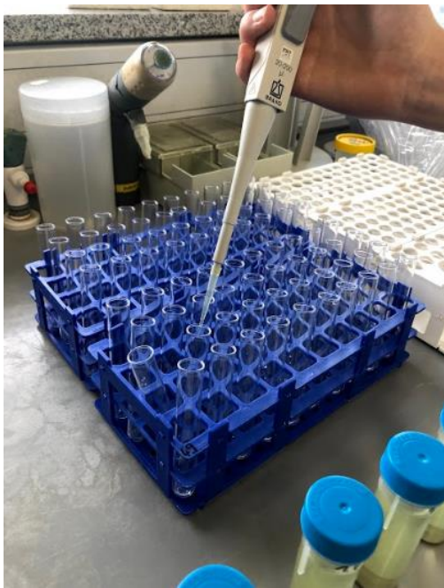
SLIKA 11: PRIPRAVA VZORCEV ZA VNOS V ICP-MS (OSEBNI ARHIV)
