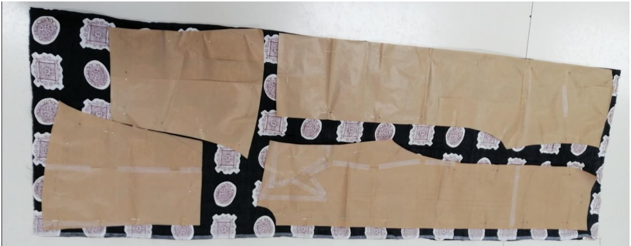
Slika 22: Polaganje krojnih delov na blago (Vir: lasten vir)
