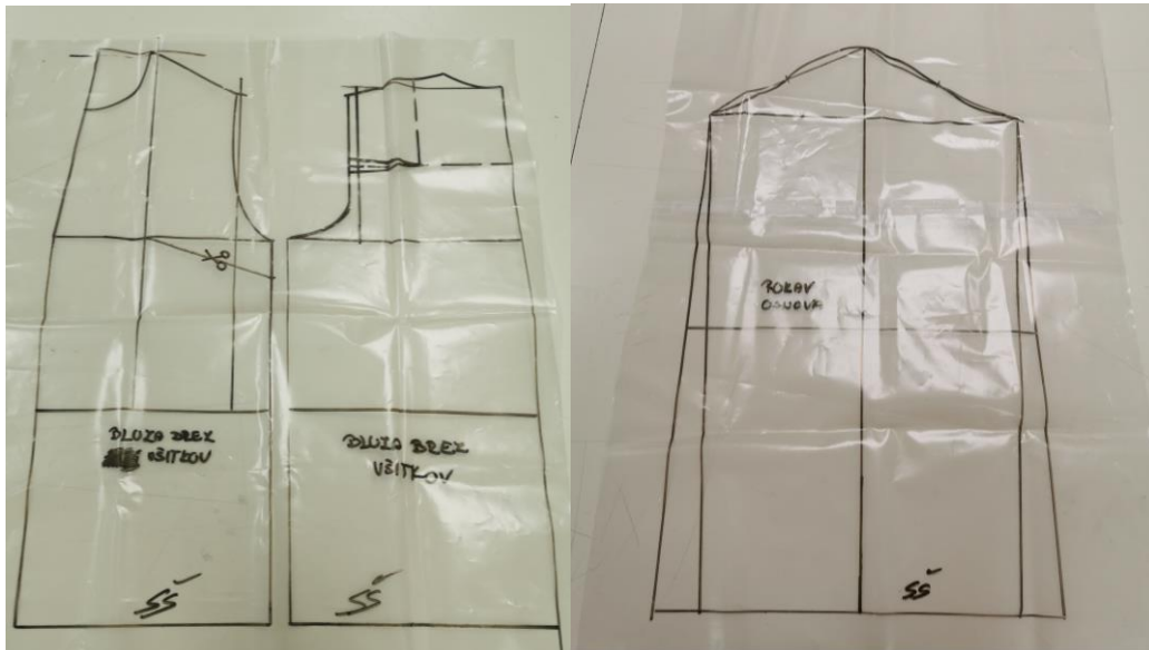
Slika 35: Osnovni kroj bluze brez všitkov (na levi) in osnovni kroj rokava (na desni)
