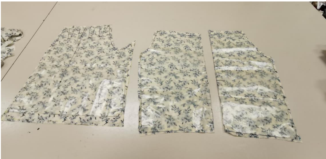
Slika 38: Skrojene deli bluže (rokav, sprednji del in zadnji del)
