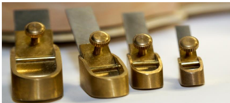
Slika 16: Skobljiči (lasten vir)
