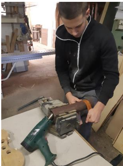
Slika 10: Prikaz krivljenja (lasten vir)
