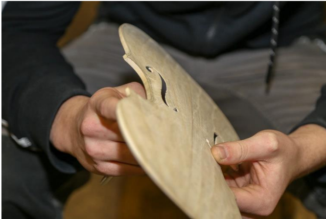
Slika 21: Prikaz fine obdelave f-odprtin (lasten vir)
