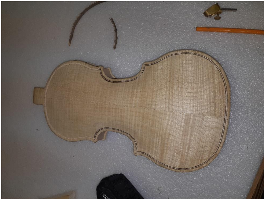
Slika 31: Prikaz vstavljenih polnil na hrbtu (lasten vir)
