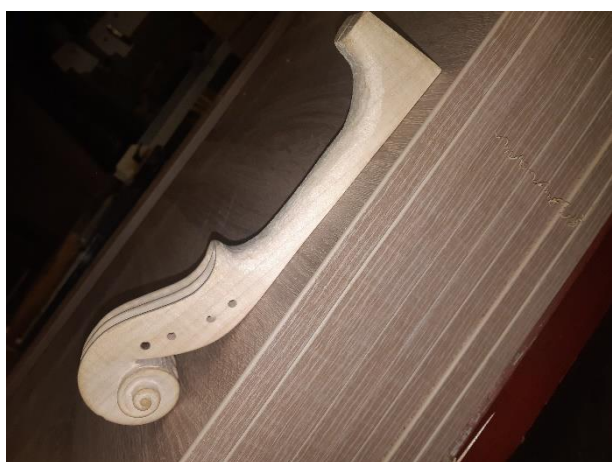
Slika 36: Skoraj končana vrat in polž (lasten vir)
