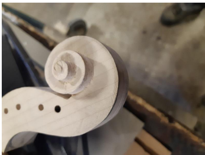
Slika 35: Prikaz spirale polža s kanali (lasten vir)
