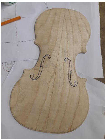
Slika 20: Zarisane f-odprtine (lasten vir)
