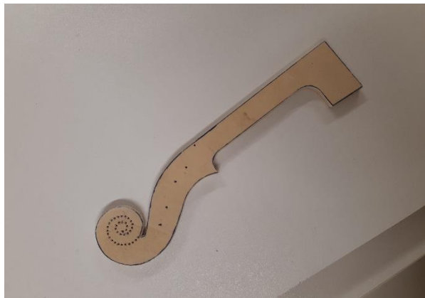
Slika 6: Šablona vratu in polža (lasten vir)
