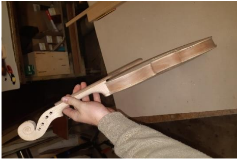
Slika 39: Zalepljen vrat na trup (lasten vir)
