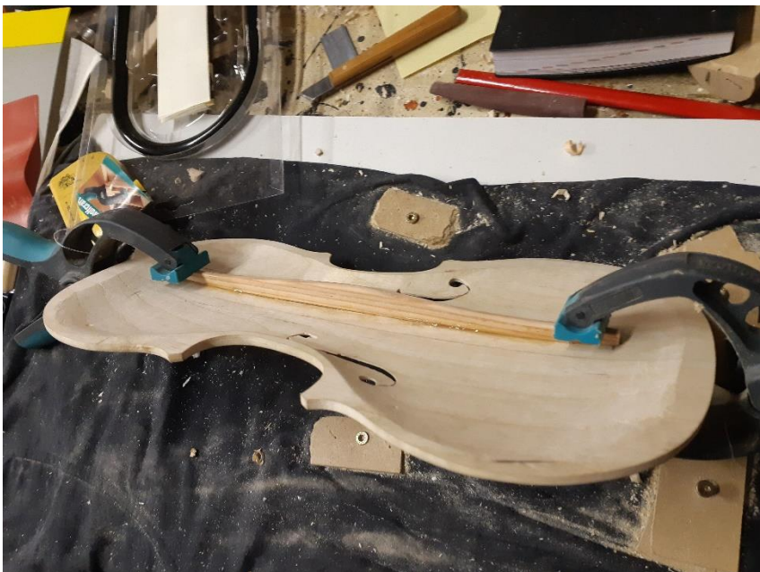
Slika 22: Zalepljen bas (lasten vir)
