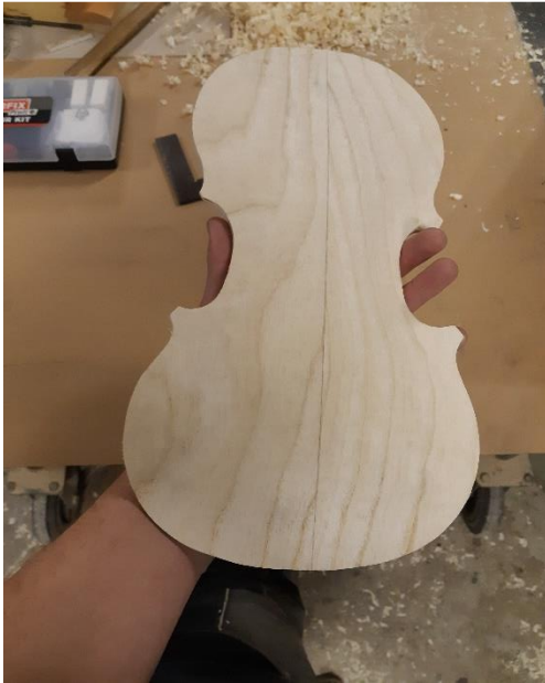
Slika 17: Površinsko obdelan pokrov( lasten vir)
