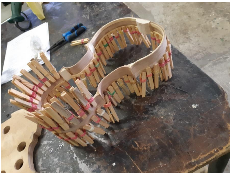
Slika 12: Jačanje oboda (lasten vir)
