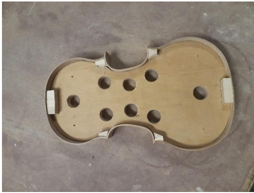
Slika 11: Zalepljen obod (lasten vir)
