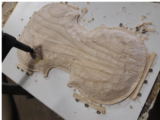
Slika 15: Groba oblika pokrova (lasten vir)
