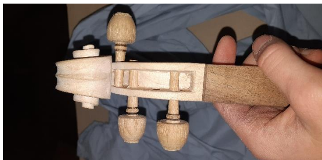
Slika 46: Grobo obdelani ročaji vijakov (lasten vir)
