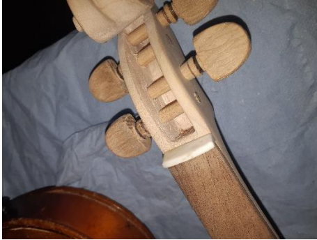
Slika 44: Kost na vratu (lasten vir)
