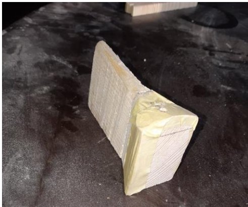
Slika 41: Šablona za vrtanje lukenj pod kotom (lasten vir)
