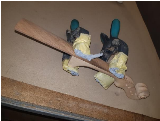
Slika 37: Umerjanje ubiralke (lasten vir)
