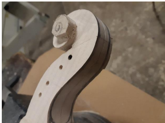
Slika 34: Groba oblika polža (lasten vir)
