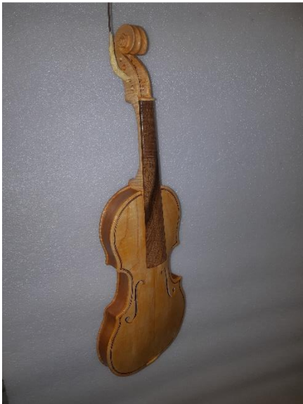
Slika 48: Prvi nanos na violino (lasten vir)
