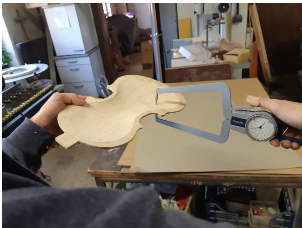
Slika 26: Preverjanje debeline hrbta (lasten vir)
