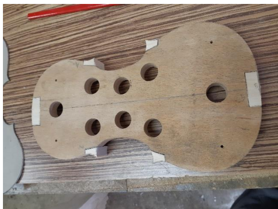
Slika 7: Šablona oboda z nosilci (lasten vir)
