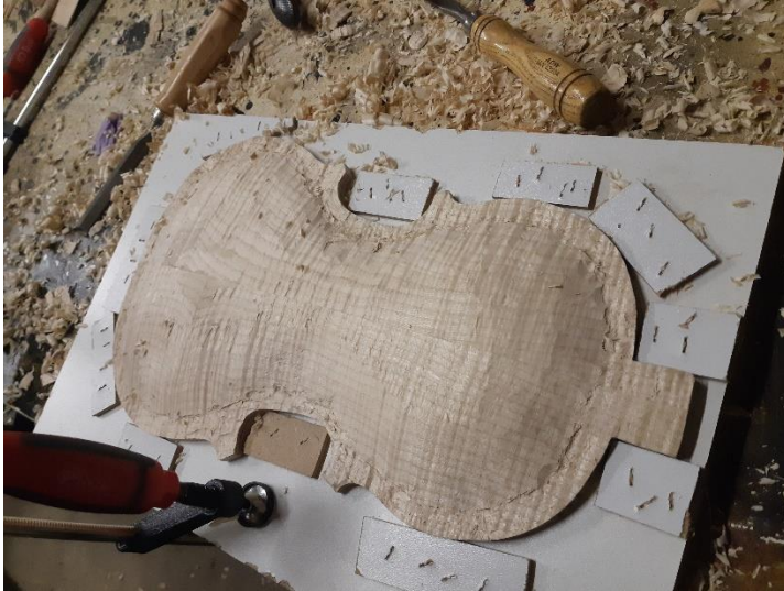
Slika 24: Groba oblika dna (lasten vir)
