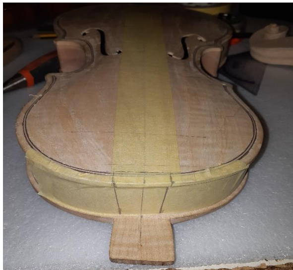
Slika 38: Zarisan utor (lasten vir)
