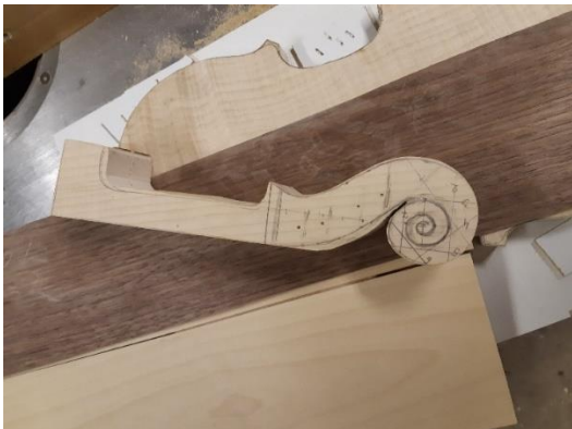
Slika 33: Prikaz vratu in polža (lasten vir)
