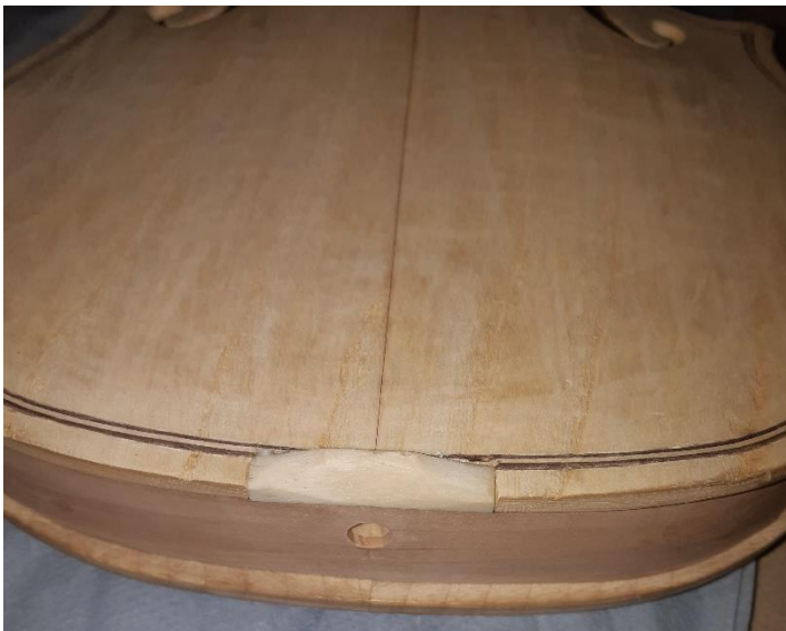
Slika 45: Vstavljena kost od spredaj (lasten vir)
