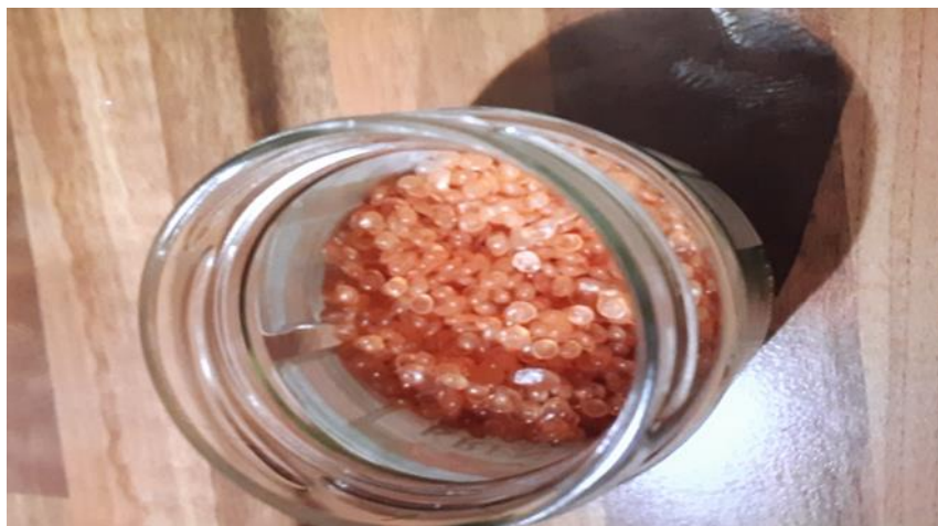
Slika 3: Klej v obliki zrn (lasten vir)
