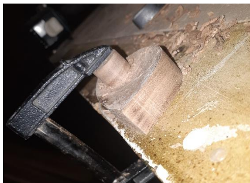
Slika 42: Groba oblika podbradka (lasten vir)
