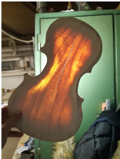
Slika 19: Prikaz debeline pokrova (lasten vir)
