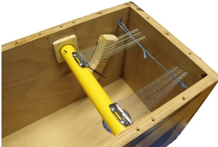
Slika 13: Sistem za premikanje mrežic. (Slikovni viri: Slika 12).
