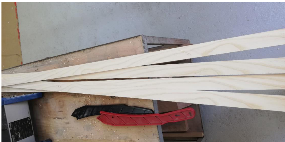
Slika 35: Vrezane in že poravnane letvice za laminiranje (vir: lasten)
