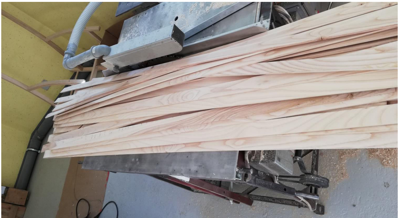
Slika 36: Rezanje in poravnavanje letvic za lepljenje v laminirane kose (vir: lasten)
