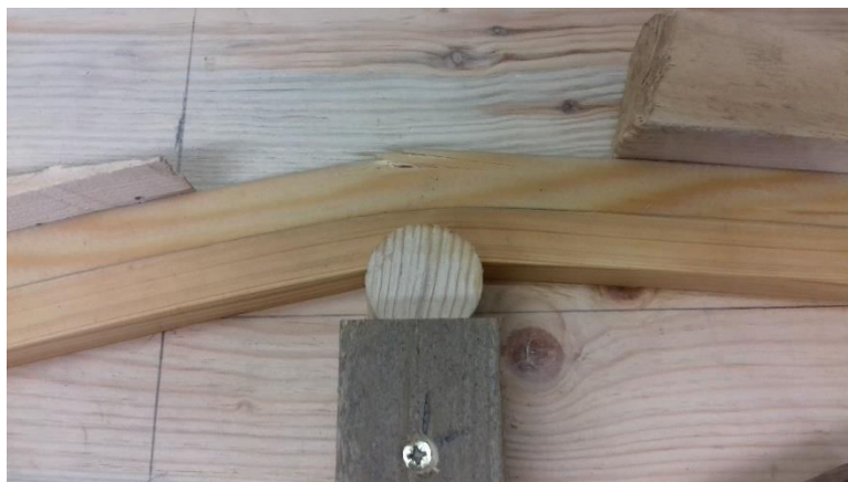
Slika 22: Prikaz tangencialnega in radialnega krivljenja lesa (vir: lasten)
