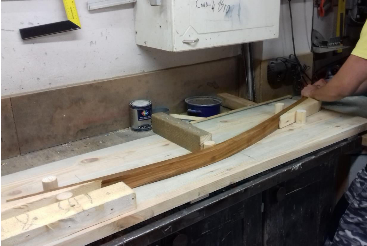
Slika 29: Vstavljanje jesena v šablono (vir: lasten)
