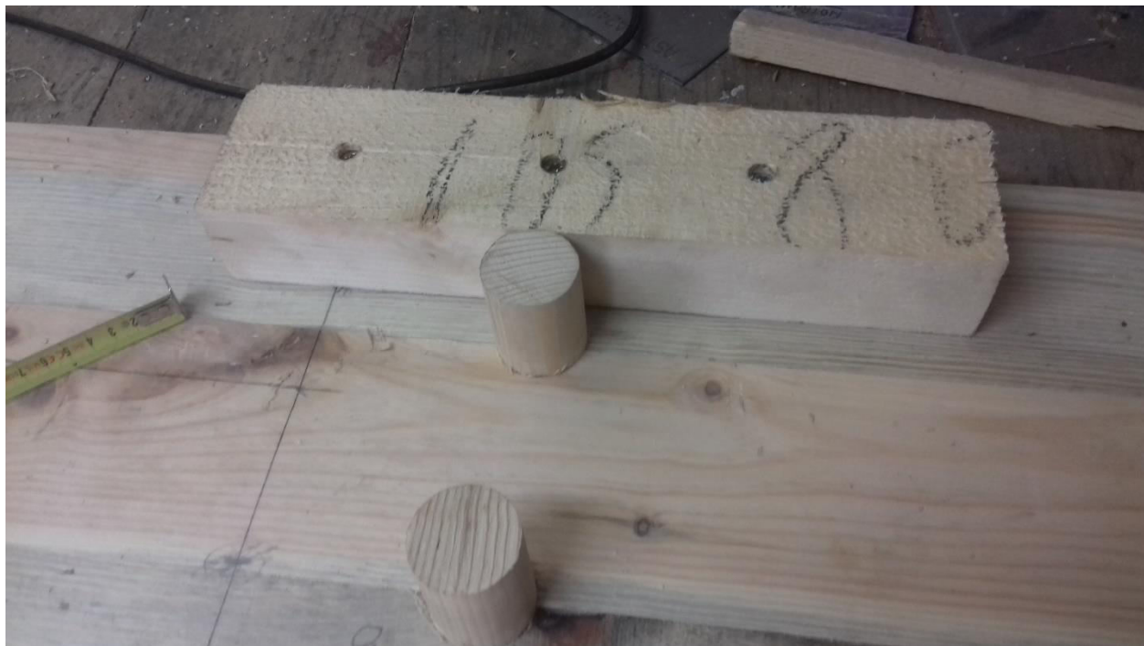
Slika 8: Dodatna opora za čepe in točka za lažje pritrdjevanja lesa v šablono (vir: lasten)
