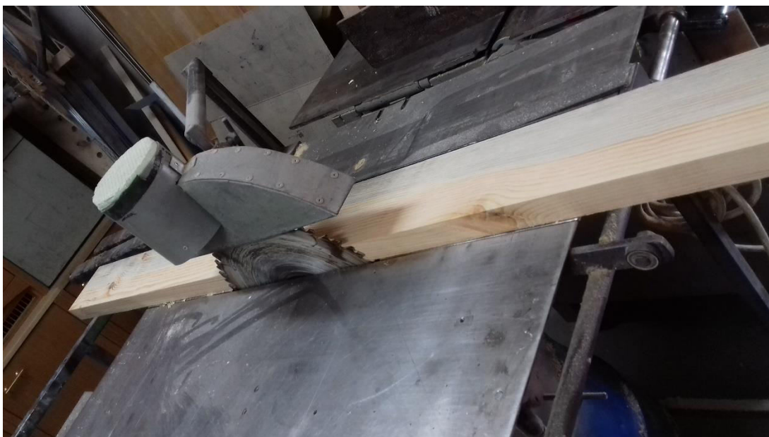
Slika 3: Rezanje in obdelovanje macesna za izdelavo šablone (vir: lasten)
