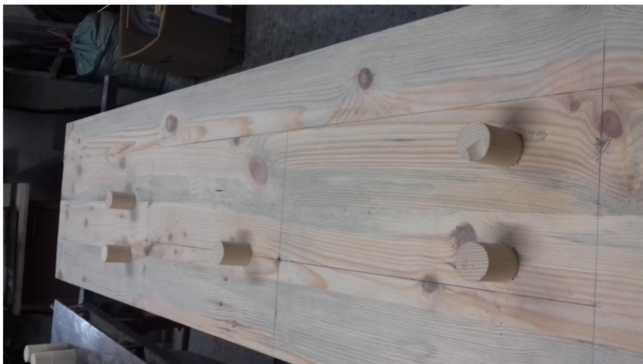
Slika 7: Vstavljanje čepov v šablono (vir: lasten)
