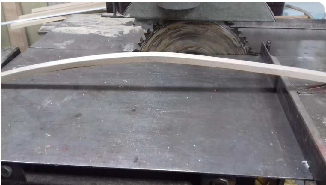
Slika 14: Posušen kos bukve, vzet iz šablone (vir: lasten)
