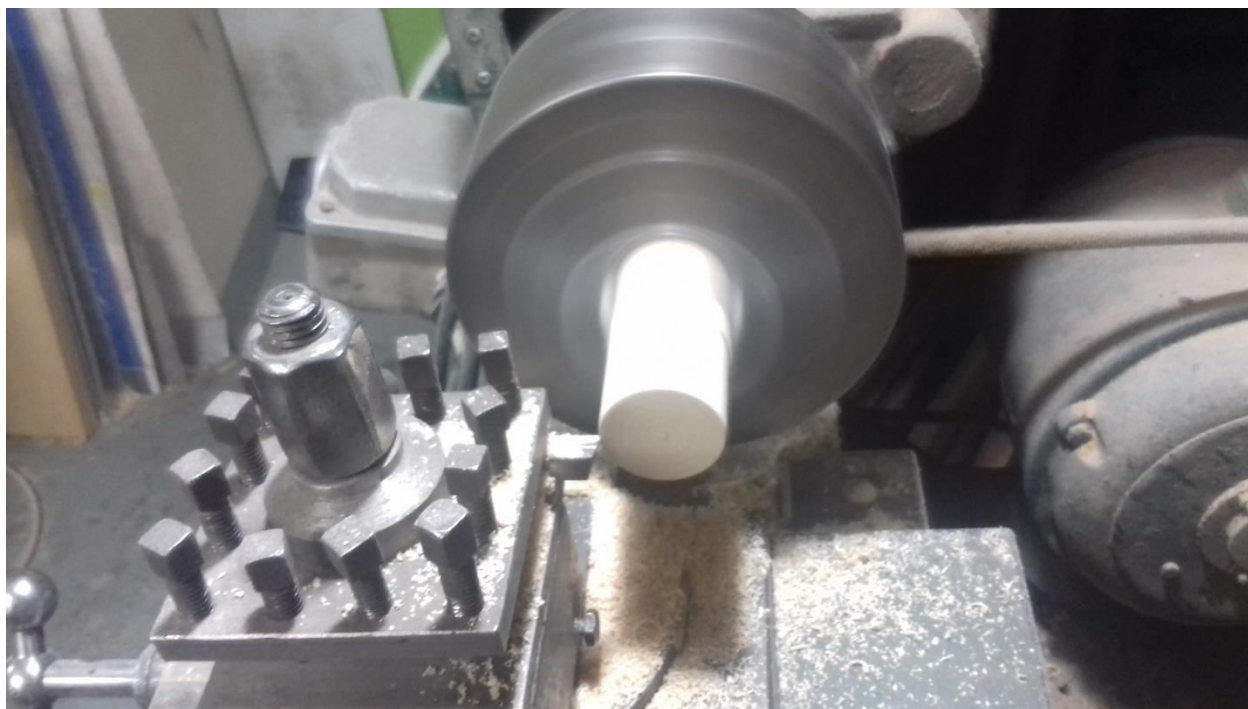
Slika 6: Izdelava čepov za zagostitev lesa na šabloni (vir: lasten)
