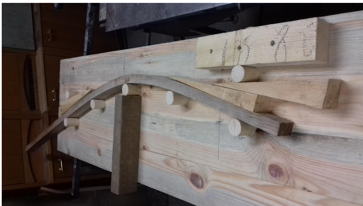
Slika 9: Prikaz vstavljanja in zagozdenja lesa v šablono (vir: lasten)
