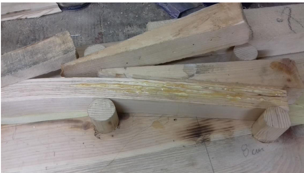
Slika 31: Izdelan laminiran kos v šablono (vir: lasten)
