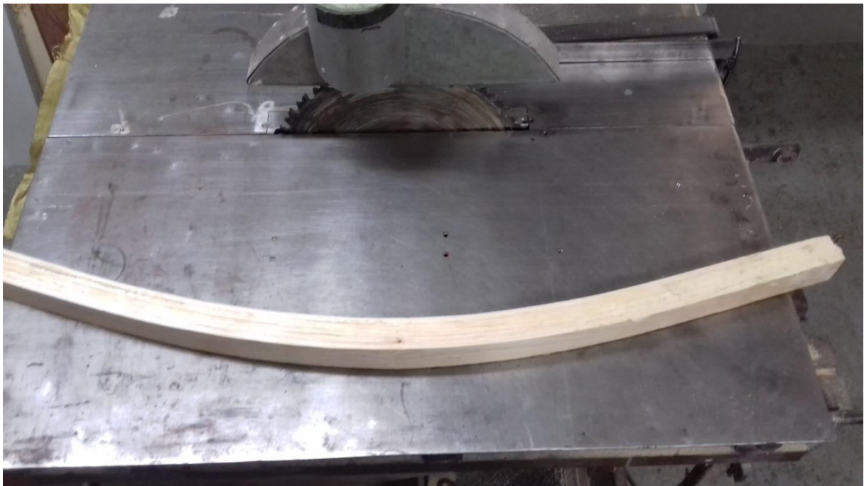
Slika 33: Posušen kos laminiranega lesa, ki je vzet iz šablone (vir: lasten)
