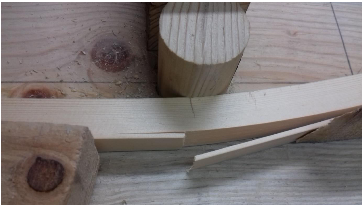
Slika 23: Prikaz šibkosti smreke ob krivljenju, kljub pravilni uporabi rasti (vir: lasten)
