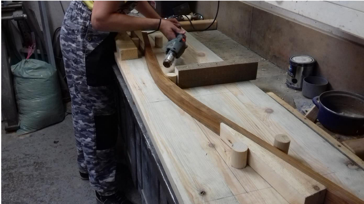
Slika 30: Hitro sušenje notranje strani jesena s posebnim fenom (vir: lasten)
