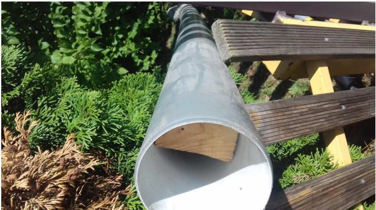
Slika 18: Les, ki se namaka v cevi, napolnjeni z vodo (vir: lasten)
