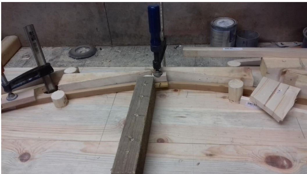
Slika 13: Postavitev lesa (bukve) v šablono (vir: lasten)
