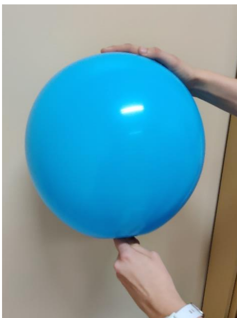
Slika 16: Merjenje prostornine zmesi s pomočjo balona.
