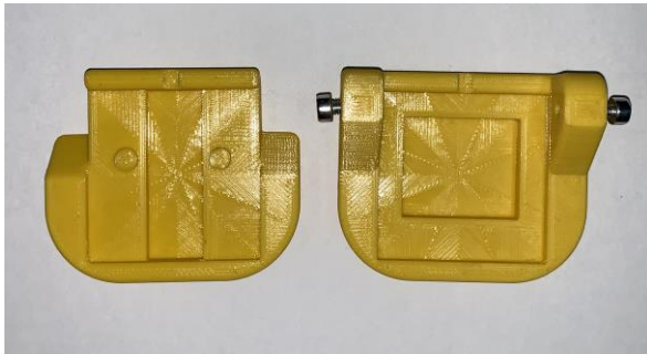
Slika 13: Ohišje za merilni senzor.
