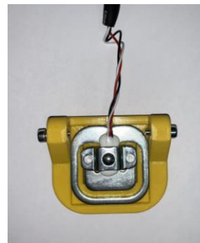
Slika 12: Merilni senzor v ohišju.
