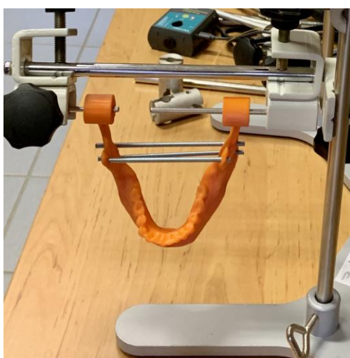
Slika 5: (levo) Replika človeške čeljusti v merilnem sistemu.
