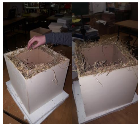
Slika 10: Vzorca 20 mm in 40 mm slame
