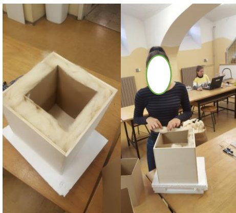
Slika 7: Vzorec 40 mm ovčje volne (Vir: lasten)
