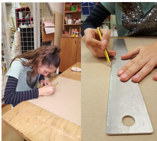
Slika 2: Zarisovanje na material (Vir: lasten)
