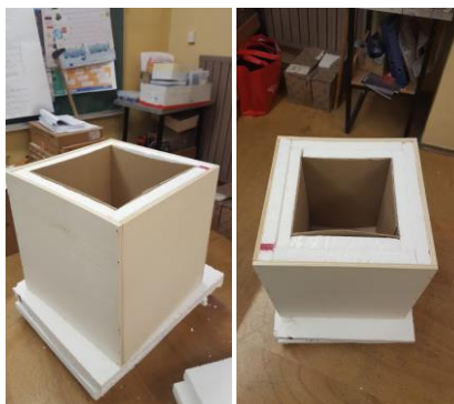
Slika 5: Vzorca 20 mm in 40 mm stiropora (Vir: lasten)
