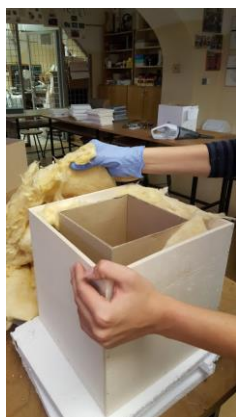
Slika 9: Vzorec 40 mm steklene volne
