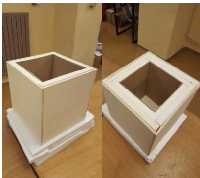
Slika 4: Vzorca 20 mm in 40 mm stirodurja (Vir: lasten)
