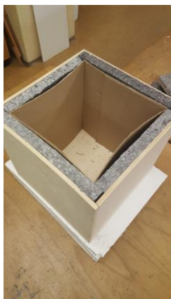
Slika 6: Vzorec 20 mm grafitnega stiropora (Vir: lasten)
