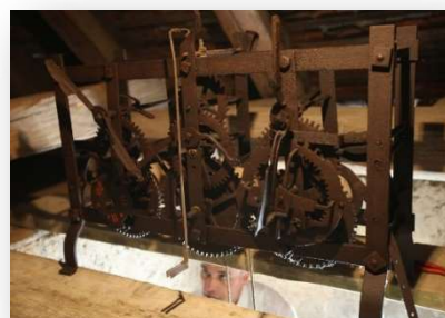
Slika 4 Mehanizem stolpne ure (Maselj, 2016)
