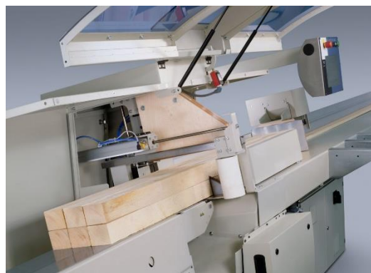
Slika 13 Čeljenje obdelovancev (Vir: https://intercet.si/izdelek/celilnik-weinig-opticut-s90 ) 8. 1. 2019
