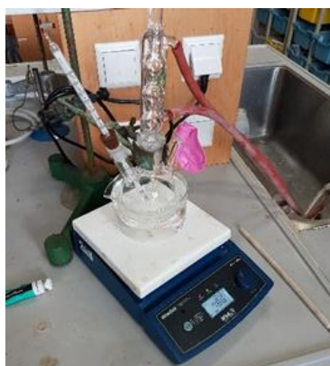
Slika 17. Aparatura za ločevanje racemne zmesi ibuprofena
