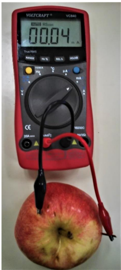
Slika 15: Merjenje kratkostičnega toka galvanskega člana iz enega jabolka
