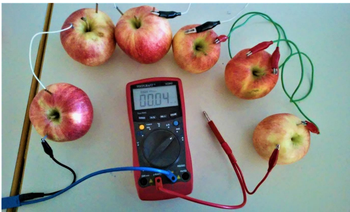
Slika 14: Merjenje kratkostičnega toka zaporedno vezanih galvanskih členov iz celih jabolk
