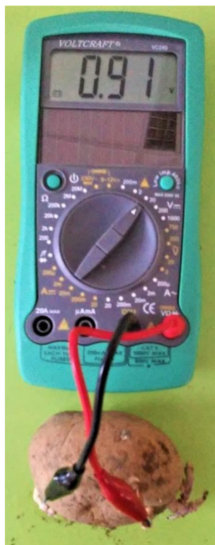
Slika 8: Merjenje napetosti galvanskega člena s krompirjem
