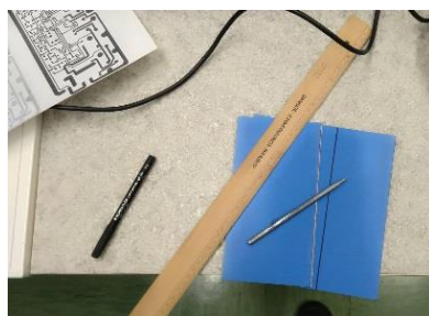
Slika 13: Rezanje ploščice po shemi (lasten vir)
