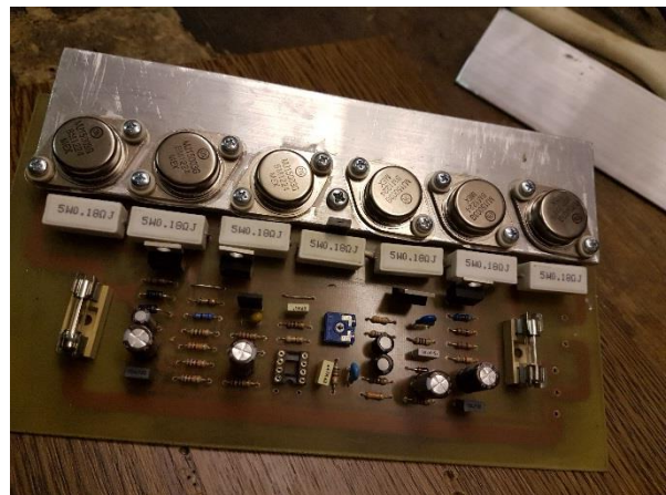
Slika 21: Pritrjen hladilnik s tranzistorji na ploščico (lasten vir)
