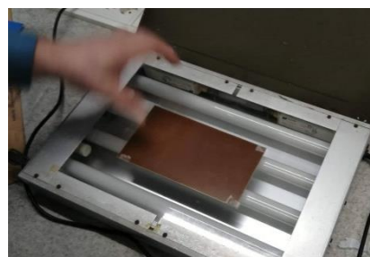
Slika 12: Ploščica s shemo pod UV svetlobo (lasten vir)
