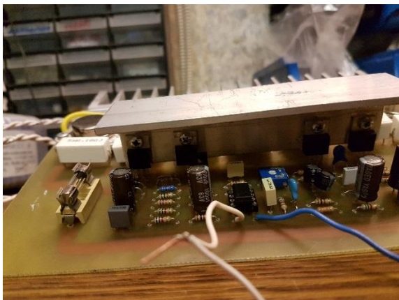
Slika 33: Hladilnik na tranzistorjih (lasten vir)
