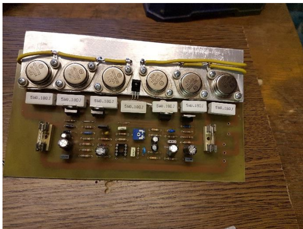
Slika 23: Pritrjen aluminij s povezanimi bazami (lasten vir)
