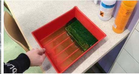
Slika 15: Jedkanje ploščice (lasten vir)
