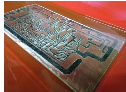
Slika 11: Jedkanje ploščice (lasten vir)
