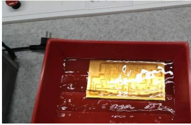
Slika 17: Ploščica v razvijalcu (lasten vir)
