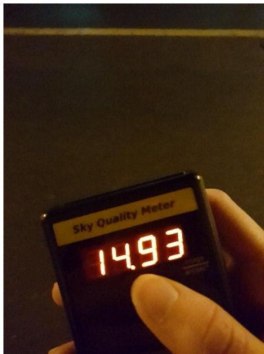
Slika 24: Merjenje s Sky Quality Metrom. (lasten vir)
