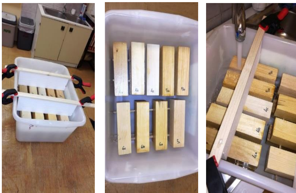
Slika 13 Namakanje vzorcev lesa (vir: lasten)
