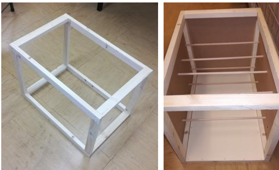
Slika 7 Nameščanje oblog na ogrodje sušilnice in razporeditev nosilnih letvic za vzorce lesa (vir: lasten)
