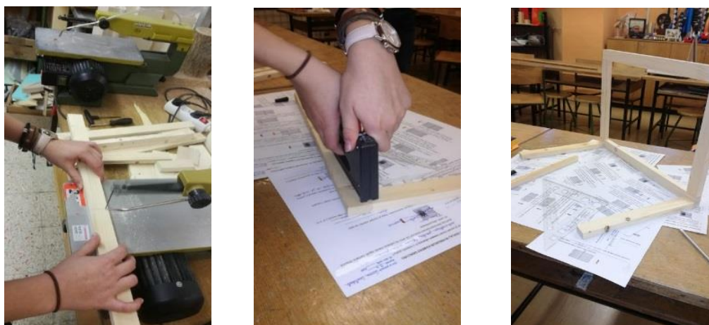
Slika 6 Izdelava okvirja sušilnice (vir: lasten)
