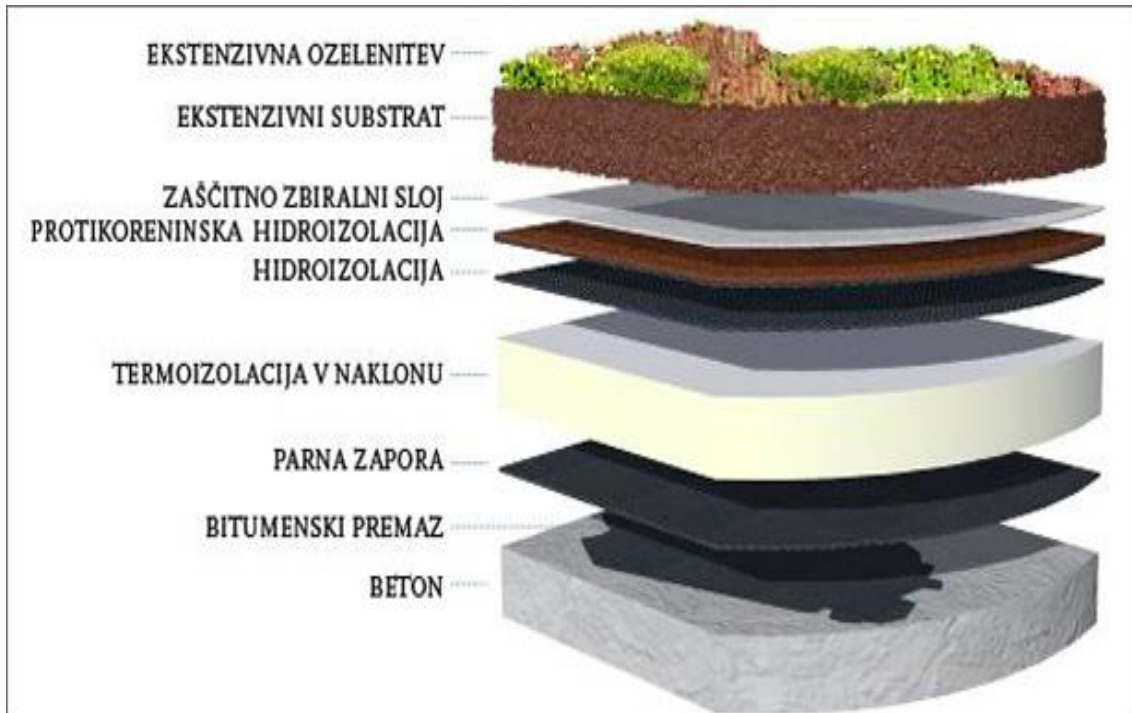
Slika 2: Prerez tople ekstenzivno ozelenjene strehe ( http://www.klemaks-gradnje.si/ ).
