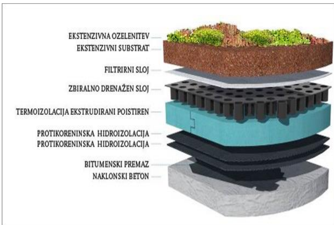
Slika 1: Prerez obrnjene ekstenzivno ozelenjene strehe ( http://www.klemaks-gradnje.si/ ).
