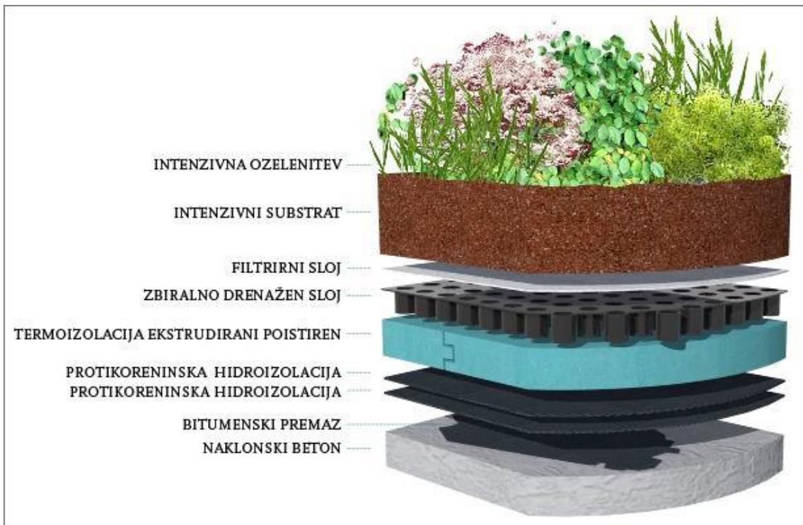
Slika 3: Prerez obrnjene intenzivno ozelenjene strehe ( http://www.klemaks-gradnje.si/ ).
