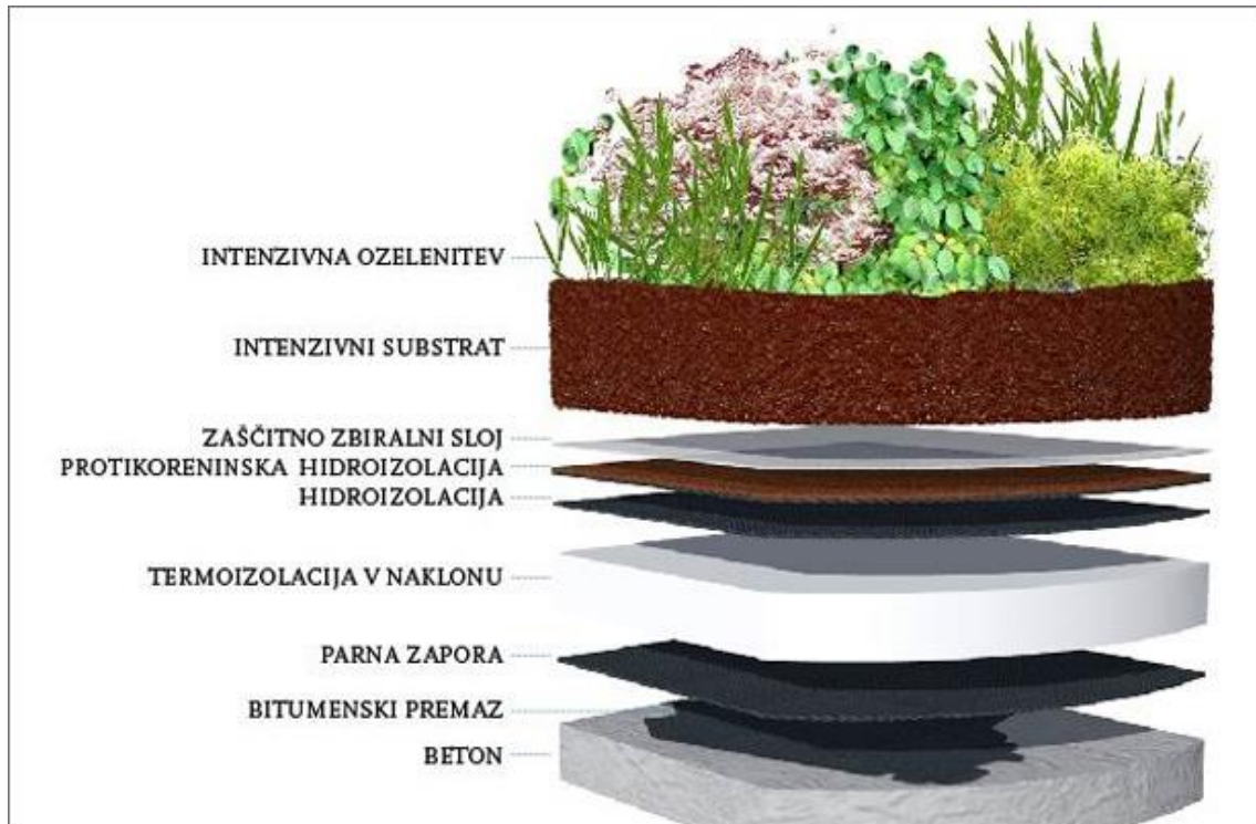
Slika 4: Prerez tople intenzivne strehe ( http://www.klemaks-gradnje.si/ ).
