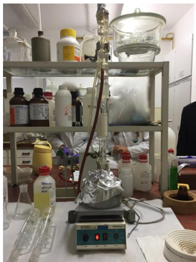
SLIKA 21: EKSTRAKCIJA PO SOXHLETU
