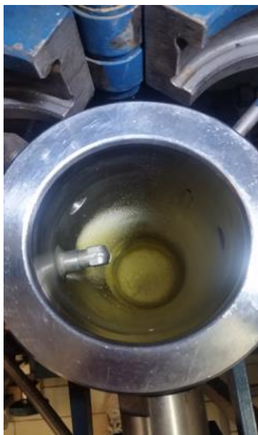
SLIKA 20: EKSTRAKT V SEPARATORJU
