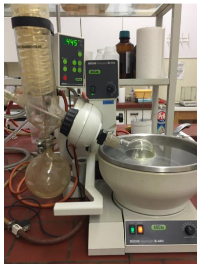
SLIKA 22: UPARJANJE TOPILA Z ROTAVAPORJEM
