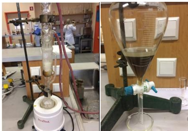
SLIKA 8: Soxhletova aparatura (levo) in ločevanje vodne in organske faze z lijem ločnikom (desno) (lasten vir)
