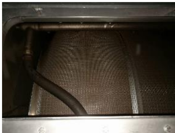
Slika 4: Rotacijsko sito med čiščenjem (Vir: lastni)
