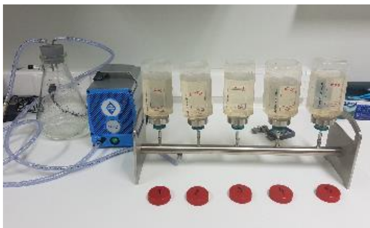
Slika 23: Filtracijska naprava z vakuumsko črpalko (Vir: lastni)
