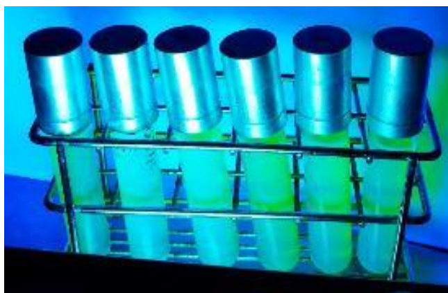
Slika 42: Vzorec potok 8 NTU po 18 urah inkubacije pri testiranju prisotnosti E. coli (Vir: lastni)
