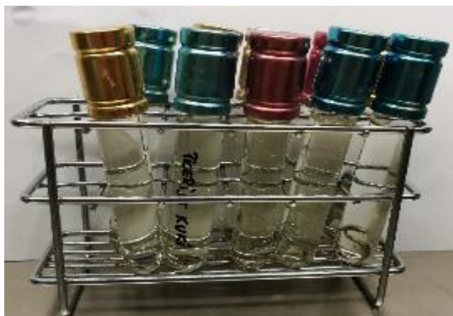
Slika 43: Vzorec Picerija Kuki po 18 urah inkubacije pri testiranju prisotnosti koliformnih bakterij (Vir: lastni)
