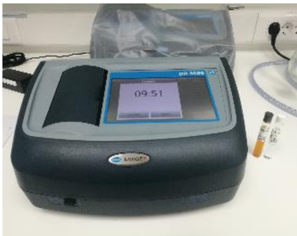
Slika 30: DR3900 Spektrofotometer s tehnologijo RFID, LCK 301 Aluminium, Zero solution in LCK 301 Aluminium, Sample cuvette (Vir: lastni)
