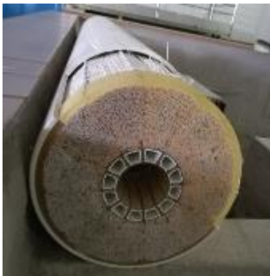
Slika 8: Prerez ultrafiltracijske membrane (Vir: lastni)
