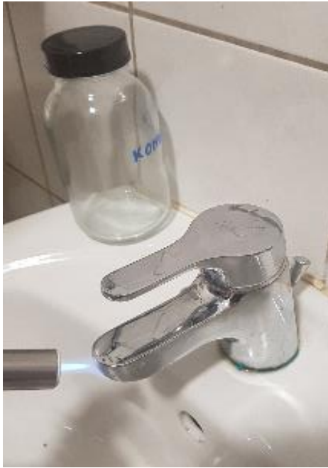
Slika 22: Obžiganje pipe (Vir: lastni)
