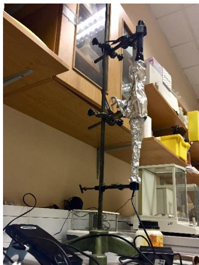
SLIKA 14: SHEMA APARATURE (LEVO) IN SESTAVLJENA APARATURA (DESNO) ZA MERJENJE HITROSTI OBARJANJA FOSFATOV
