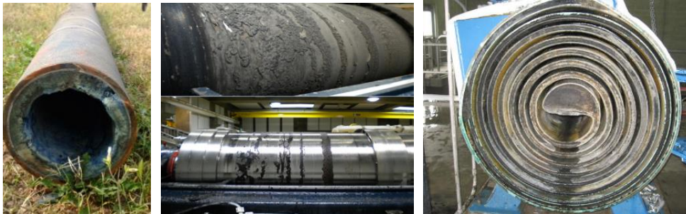
SLIKA 10: STRUVIT V ODVODNIH CEVEH, NAPRAVI ZA CENTRIFUGIRANJE IN GRELCU VODE (VIR: http://www.struvite.info/struvite_formation (citirano 15.1. 2018))
