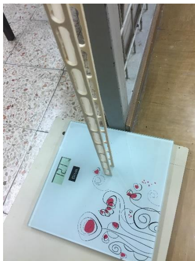
Slika 12 Merjenje kritične uklonske sile s pomočjo osebne digitalne tehtnice (vir: avtorice)
