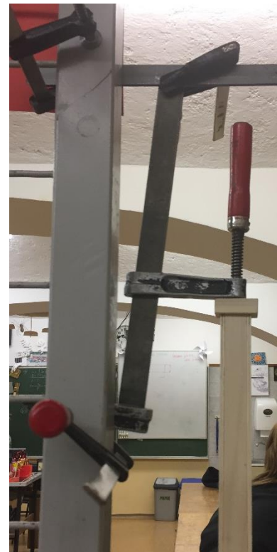
Slika 11 Spreminjanje tlačne sile z vijakom mizarske svore (vir: avtorice)
