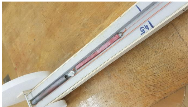
Slika 1 Nosilec podvozja iz stirodura ni imel dovolj velike trdnosti (vir: avtorice)
