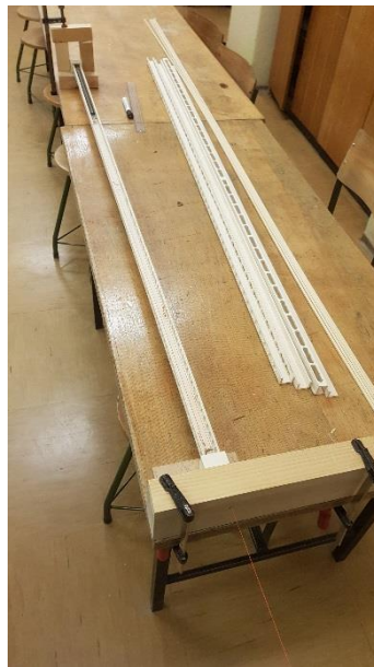
Slika 13 Postopek preizkušanja uklonske trdnosti podvozja elastomobila (vir: avtorice)
