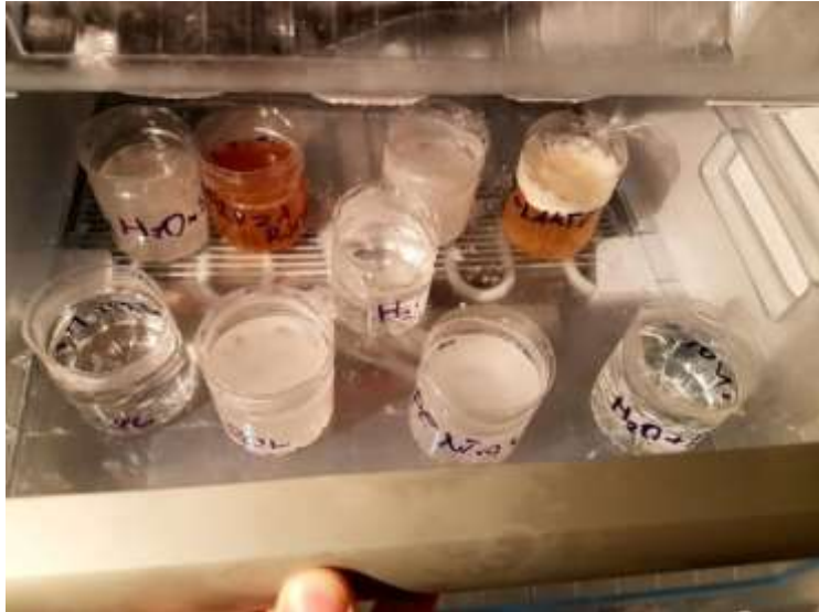
Slika 7: Vodne raztopine polarnih kovalentnih snovi v zamrzovalniku
