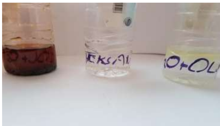
Slika 9: Netopnost nepolarnih kovalentnih snovi v vodi
