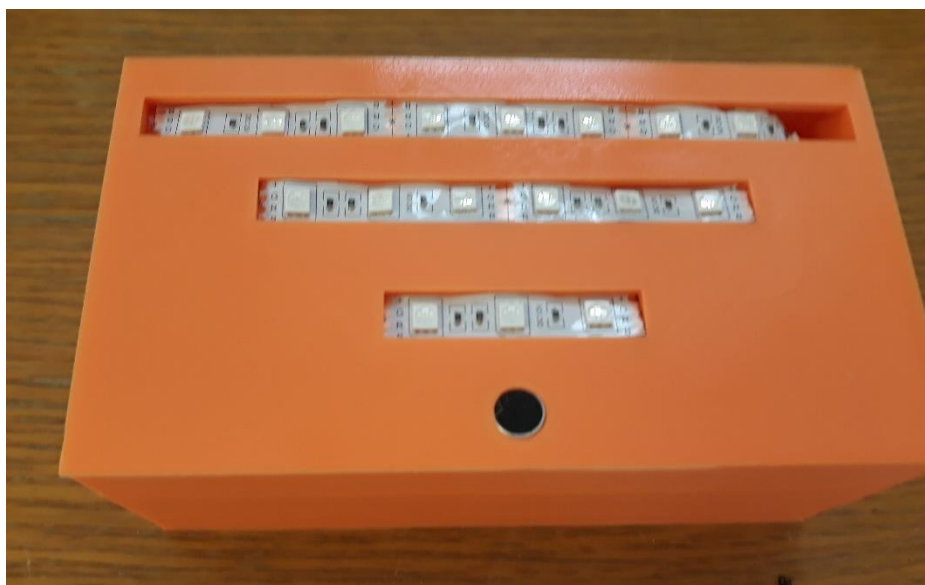
Slika 21: Slika s vsemi lučkami ter zvočnikom v ohišju (osebni arhiv)
