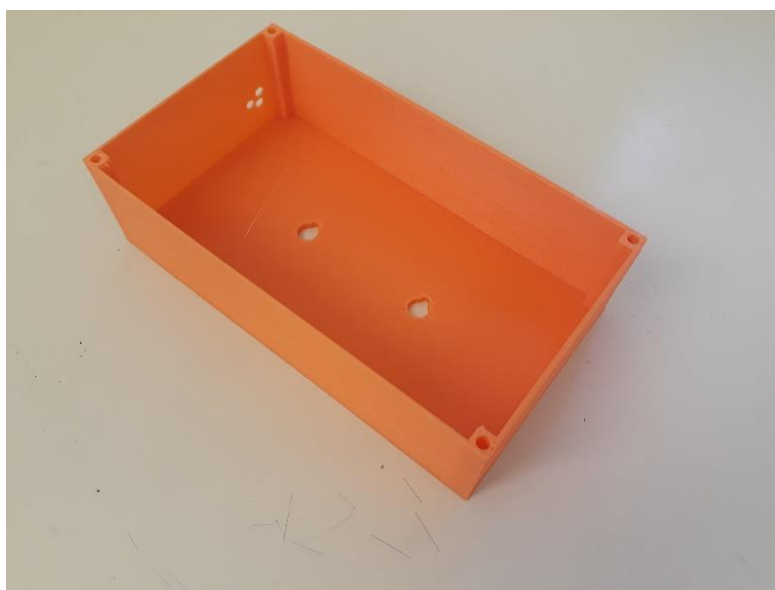
Slika 17: Spodnji del ohišja merilnika hrupa (osebni arhiv)
