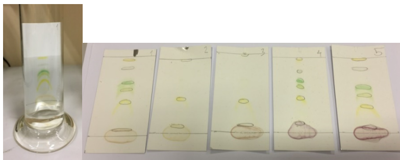
SLIKA 20. Od leve proti desni; razvijanje kromatograma (TLC) in kromatogrami lista ambrovca (zeleni, rumeni, oranžni, rdeči in zeleno-rdeči)
