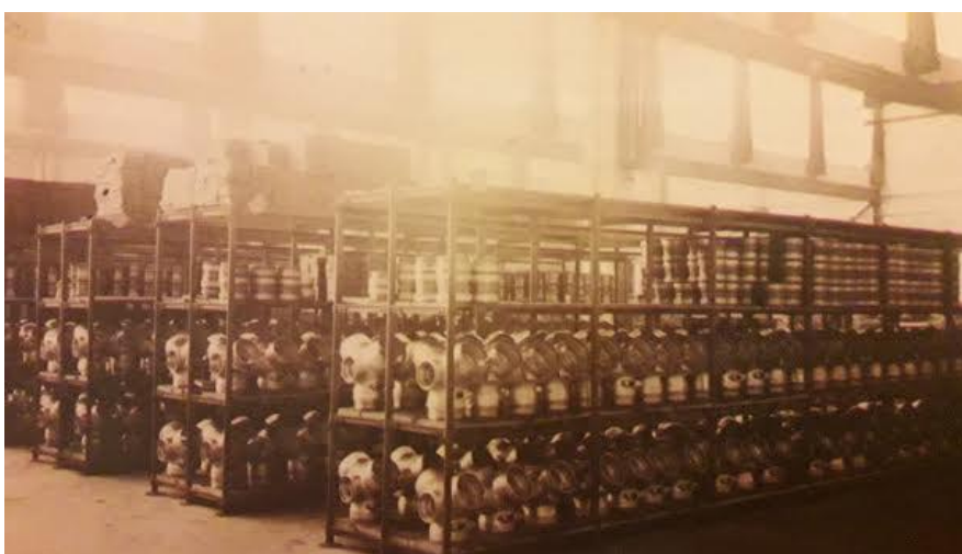
Slika 23: »Eden redkih dokumentiranih dokazov proizvodnega programa v nekdanji "VDM Luftfahrtwerke Steiermark GmbH" na Teznu: pesta (okrovi) pogona letalske elise 103 . Izdelovali pa so tudi polžasto planetno gonilo letalskih elis.« 104
