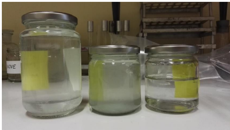
Slika 20 Vzorci vode: Pred dodajanjem E. coli, pred filtracijo in po filtraciji
