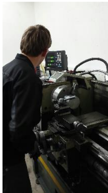
Slika 16: Struženje na univerzalni stružnici
