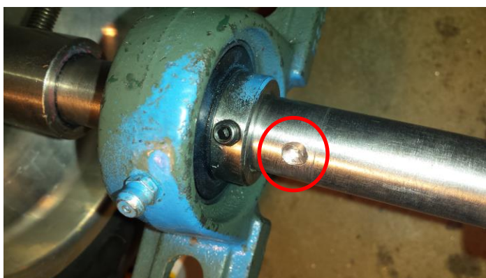
Slika 46: Povrtanje osi za vijak ležaja
