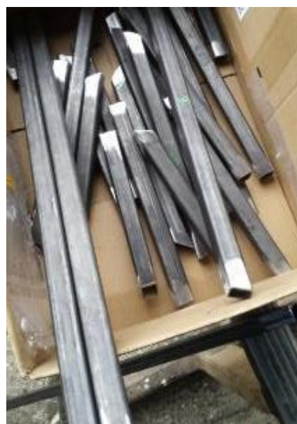
Slika 6: Profili s pobrušenimi robovi
