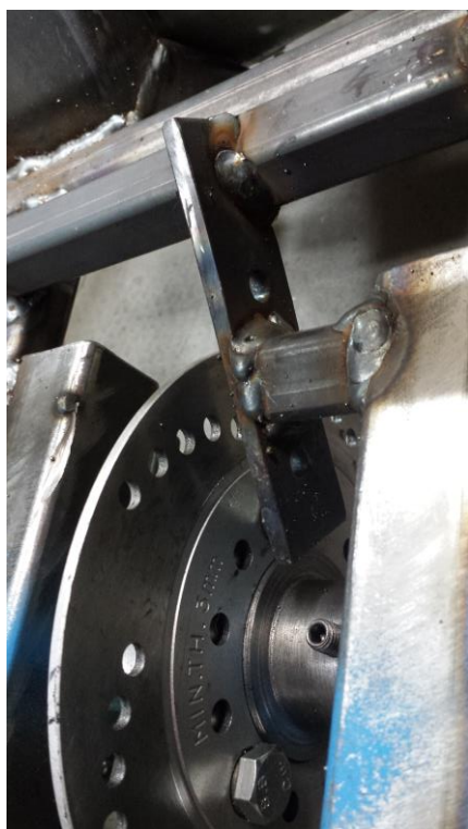
Slika 57: Nosilec namenjen zavornim kleščam
