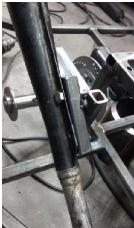
Slika 59: Nosilec izpušne cevi
