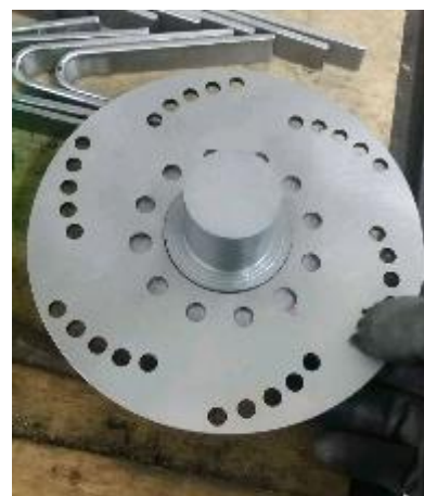
Slika 21: Tesno prilegajoč zavorni disk k stopnički nastavka
