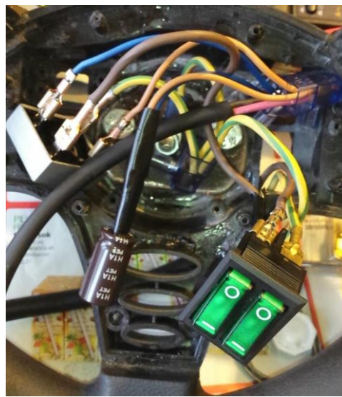
Slika 72: Električna napeljava v volanu
