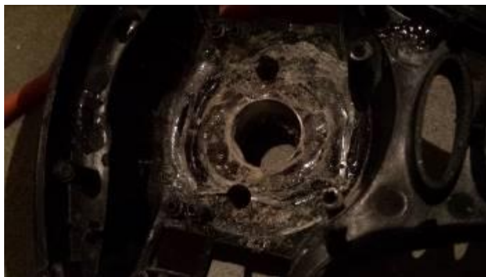
Slika 38: Volan zalit z epoksi smolo
