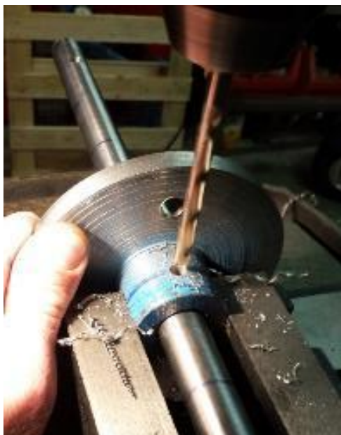
Slika 48: Vrtanje luknje z namiznim vrtalnim strojem
