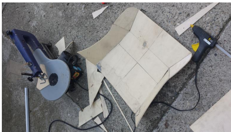
Slika 62: Rezanje vezane plošče z dekopirno žago
