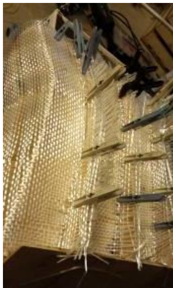
Slika 65: Steklena vlakna pred nanosom smole
