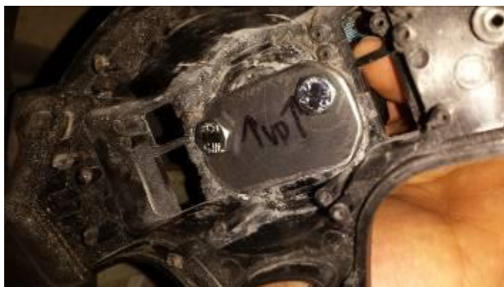
Slika 39: Ojačitev z železno ploščico
