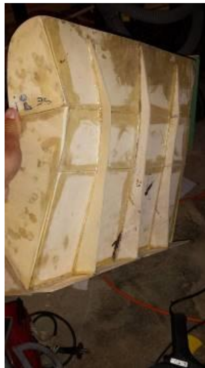
Slika 64: Dodatne ojačitve na zadnji strani
