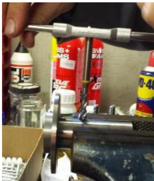
Slika 49: Rezanje navoja za imbus vijake
