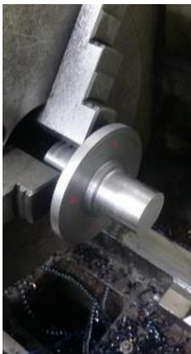
Slika 17: Vpenjalna glava in obdelovanec
