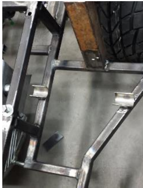
Slika 26: Nosilca za zaganjač
