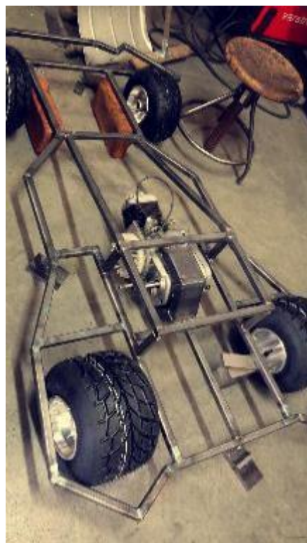
Slika 8: Osnovna konstrukcija z motorjem
