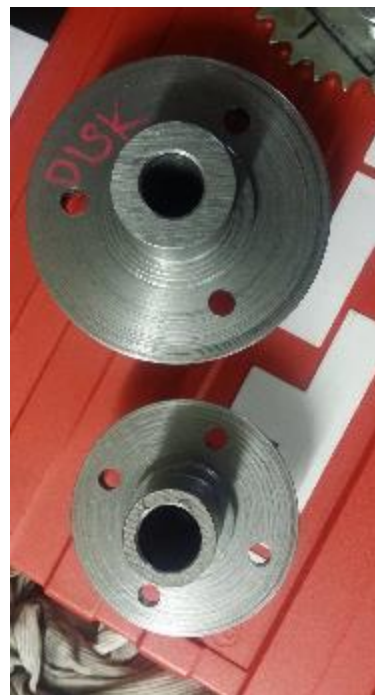
Slika 19: Nastavka za zobnik in zavorni disk z izvrtanimi luknjami
