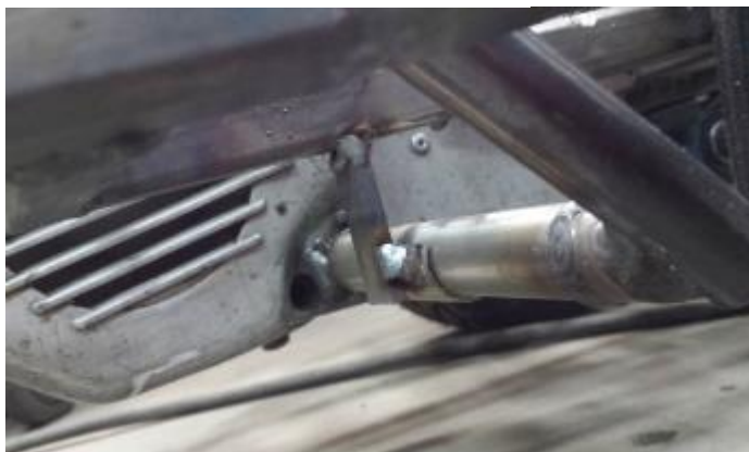
Slika 30: Nosilci menjalne ročice
