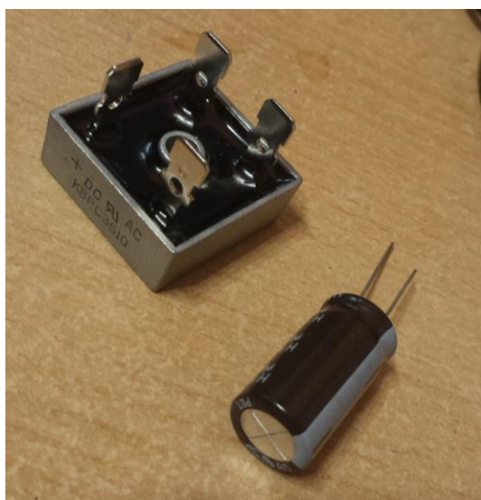
Slika 71: Graetz in kondenzator
