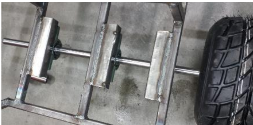
Slika 9: Zadnji nosilci za ležaje
