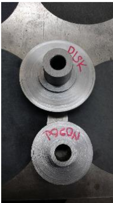
Slika 18: Nastavka za zobnik in zavorni disk brez lukenj
