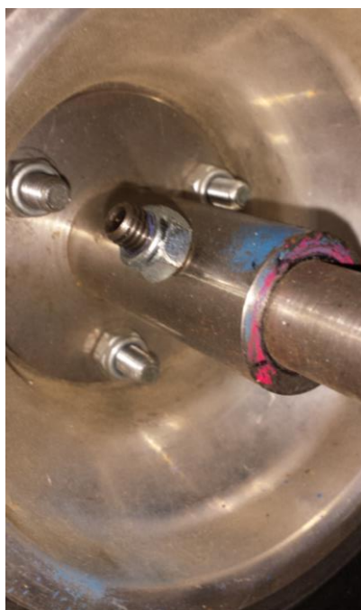
Slika 50: Pritrditev platišča na os
