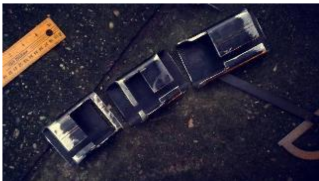
Slika 23: Nosilec za motor pred varjenjem
