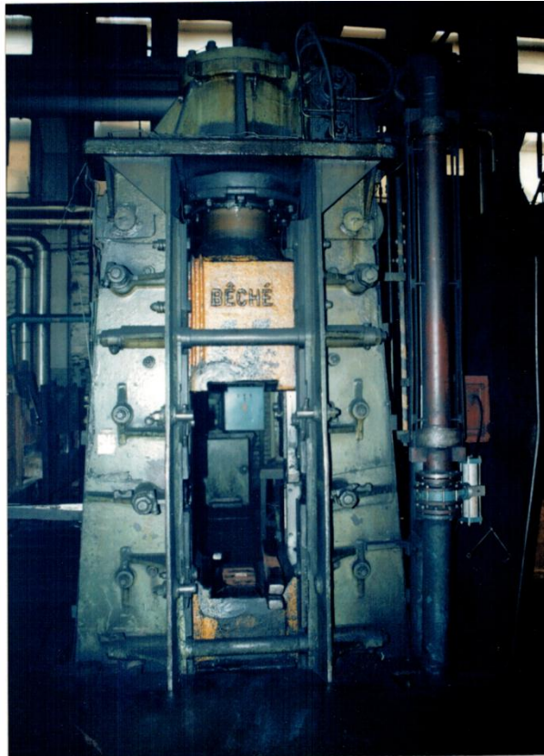
Slika 24: proti udarno kladivo v TAM-U [4]
