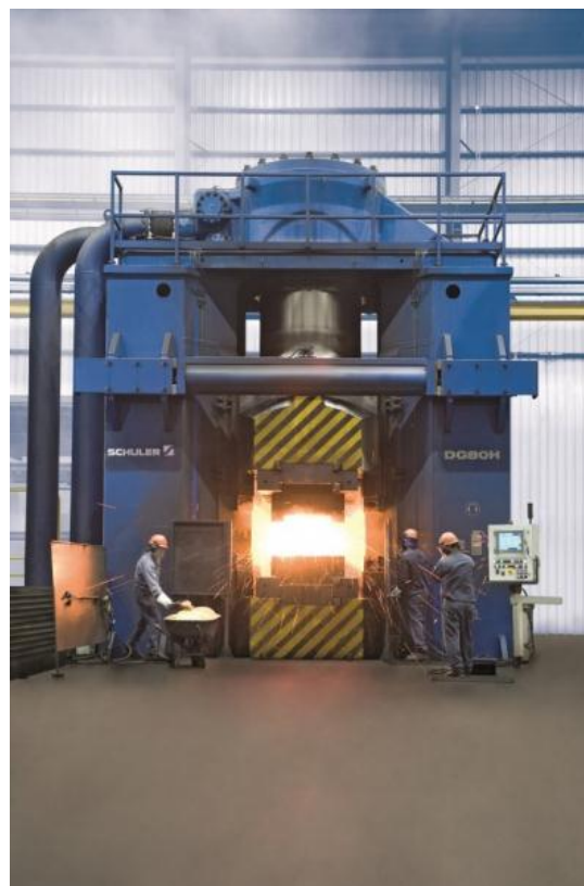
Slika 25: sodobno protiudarno kladivo [3]
