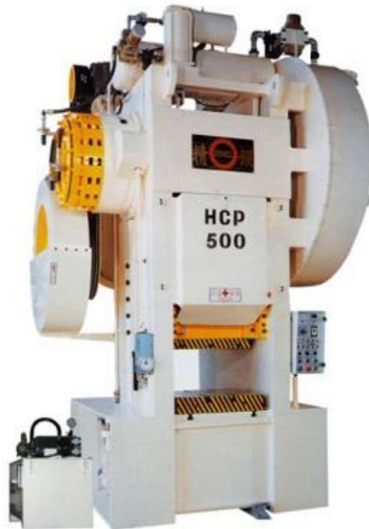
Slika 21: sodobna escentrska stiskalnica [3]
