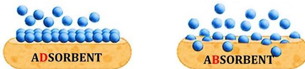
Slika 3. Primerjava adsorpcije (levo) in absorpcije (desno)
