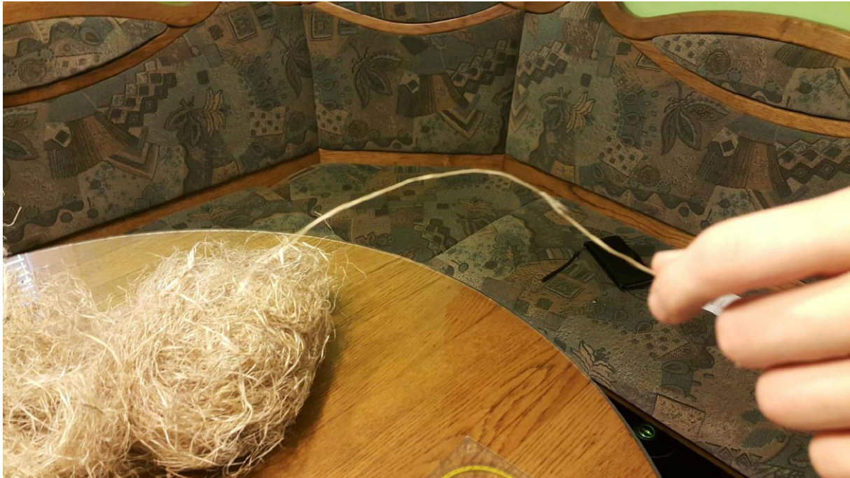
Slika 14: Ločevanje vlaken konoplje za preizkus (lastni vir)
