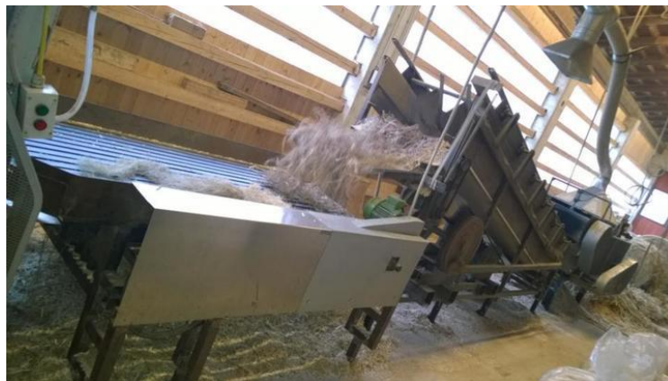
Slika 7: Mehansko trenje konopljinih stebel v konopljarni na Vranskem ( http://www.hannah-biz.si/ )
