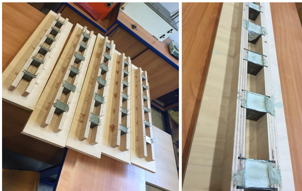
Slika17: Preizkušanci v kalupih pred in tik po vgraditvi (lastni vir)
