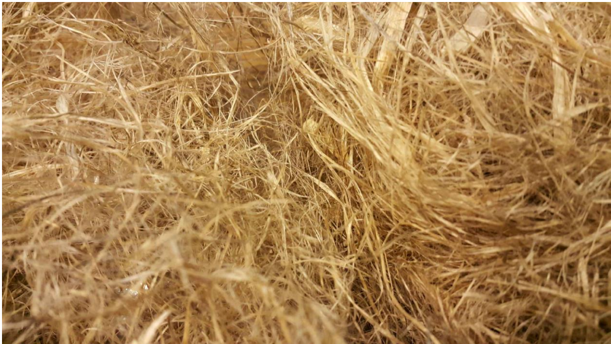
Slika13: Vlakna konoplje pripravljena za preizkus (lastni vir)
