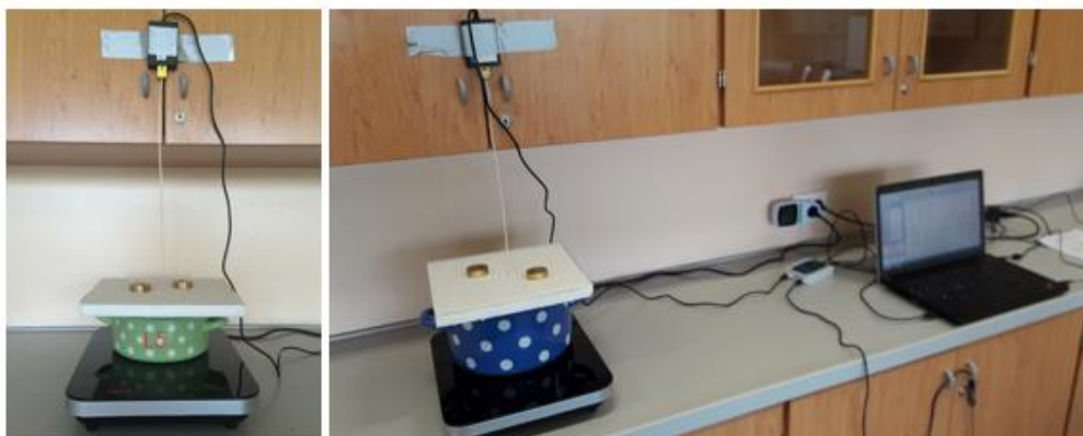
Slika 19: Postavitev eksperimenta pri merjenju izkoristka v odvisnosti od premera lonca, lonec L5( levo) in lonec L8 (desno).
