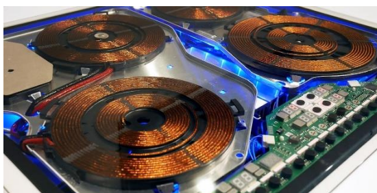
Slika 1: Notranost indukcijskega kuhalnika, velika bakrena tuljava ustvarja magnetno polja.
