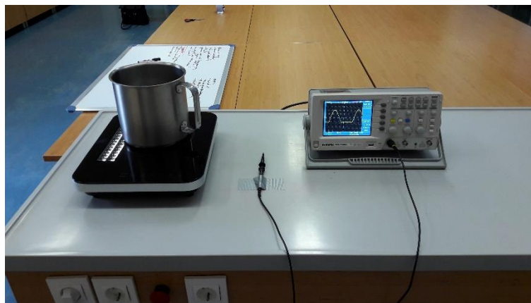
Slika 4: Merjenje frekvence delovanja s sondo in osciloskopom.
