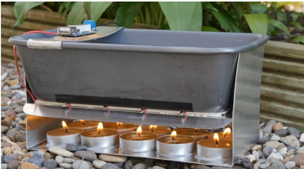
Slika 14: Testiranje delovanja peltierjevih plošč na ognju (Vir: naveden med viri slik)
