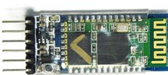
Slika 2: Bluetooth modul HC-05 (spredaj in zadaj)
