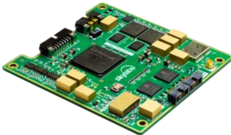
Slika 11: Matična plošča NANOobc
