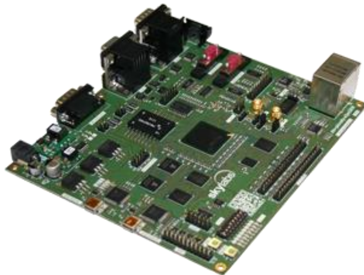
Slika 9: Matična plošča PicoSky™ ProASIC3
