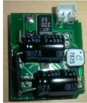
Slika 12, Modificirano vezje z napetostnim pretvornikom LTC3108
