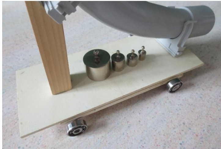
Slika 28: Avtomobilček z malimi kolesčki , dodatno obtežen z utežmi
