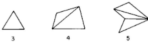
Slika 3: Triangulacija poligona na trikotnike iz istega oglišča in je n = 3, 4 in 5 (O'Rourke, 1987, str. 6).
