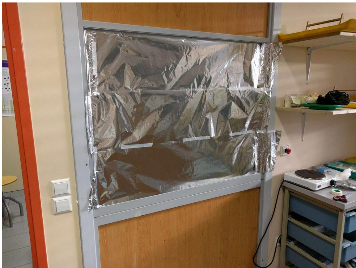
Slika 9: Zaščita digestorija z alufolijo (lasten vir)
