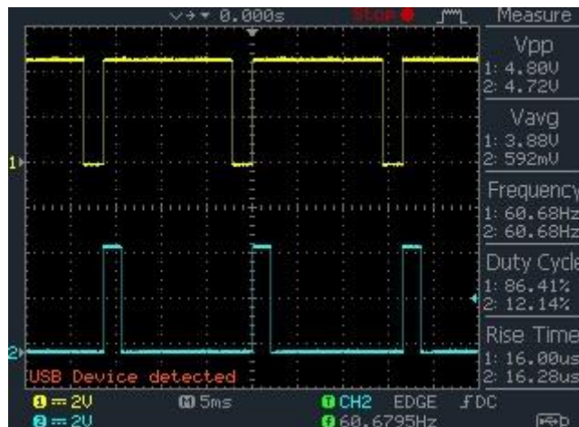
Slika 9: Prikaz PWM signalov (pin 6 zgoraj, pin 5 spodaj).
