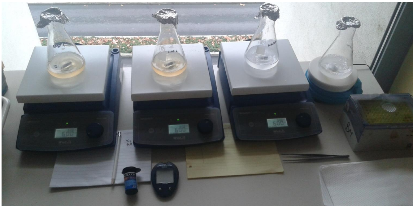
Slika 3: Erlenmajerice z vzorci na magnetnih mešalih (lasten vir)
