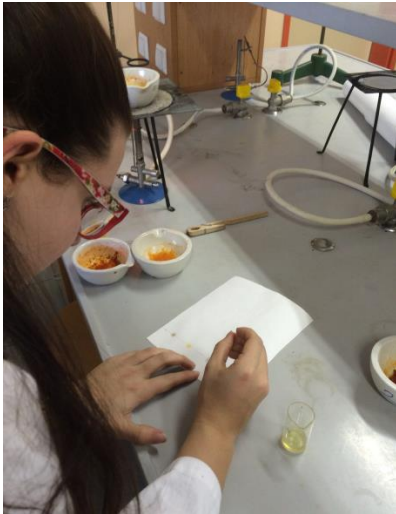
Slika 12: Nanašanje vzorcev ekstraktov na filtrirni papir
