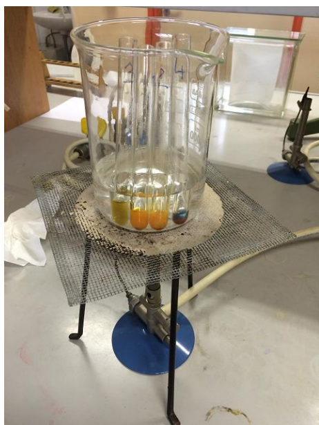
Slika 17: Določanje ogljikovih hidratov – vodna kopel
