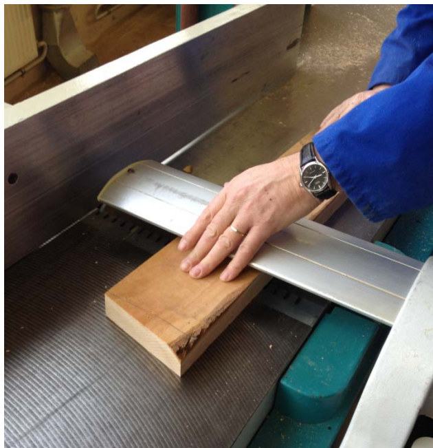
SLIKA 21: Kotno poravnavanje na poravnalnem skobeljnjem stroju
