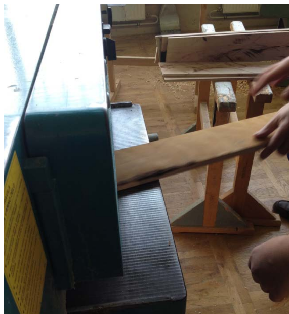
SLIKA 24: Debelinsko skobljanje lamel
