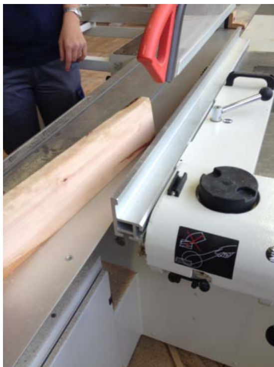
SLIKA 23: Razrezovanje na formatni krožni žagi
