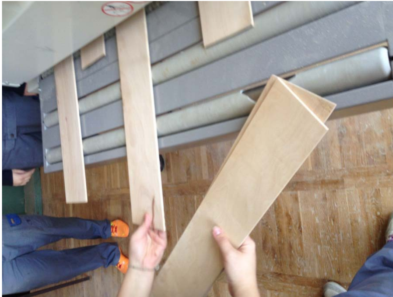
SLIKA 28: Končno brušenje lesa
