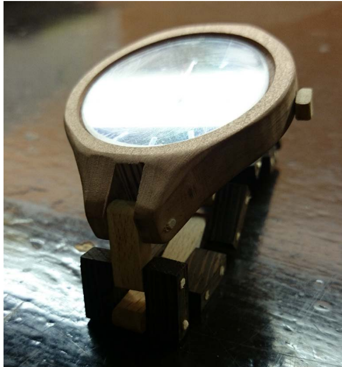
SLIKA 46. Povezovanje pasa z mehanizmom (lasten vir)
