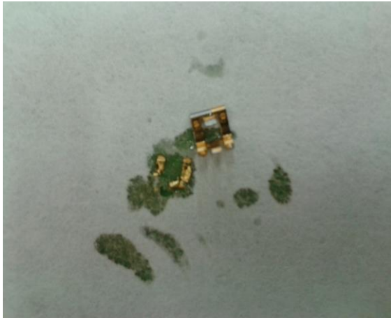
Slika 27: Delec, ki sem ga dobil po raztapljanju v žvepovi(VI) kislini. (Foto: Avtor naloge.)
